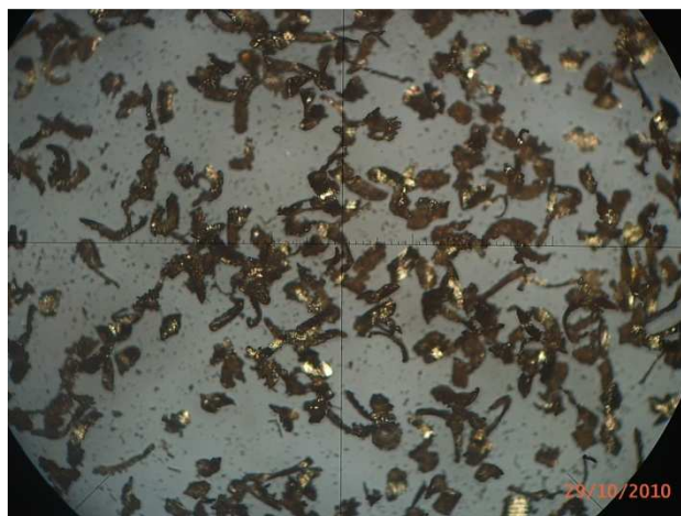
Figura 3.12. Fotografía del material retenido en la malla #270, correspondiente a 53 [ \mu\text{m} ], mediante microscopía óptica de luz reflejada (100 aumentos)
