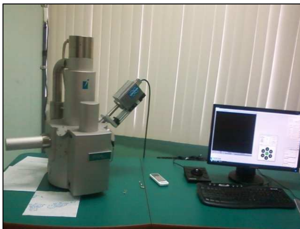
Figura 2.2. Fotografía del Microscopio electrónica de barrido, TESCAN, empleado en el análisis de elementos
