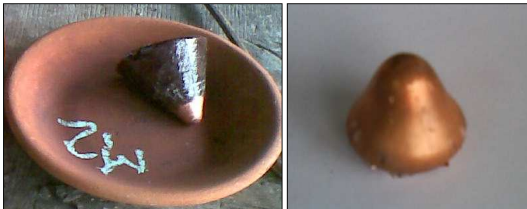
Figura 3.16. Muestras pretratadas, después de fusión con carga típica fundente en horno de crisol a gas
