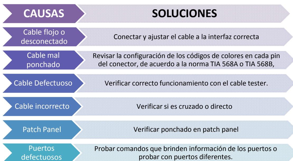
Figura 4.97 Causas y soluciones a problemas de cableado
