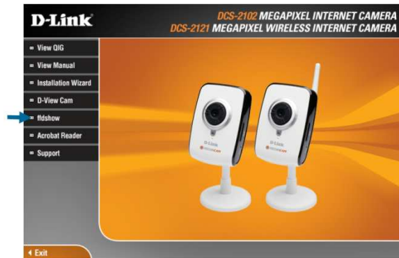
FIGURA 3.27 INSTALACIÓN CODEC CÁMARA IP
