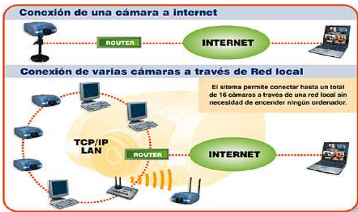
FIGURA 2.16 CONEXIÓN DE CÁMARAS IP
