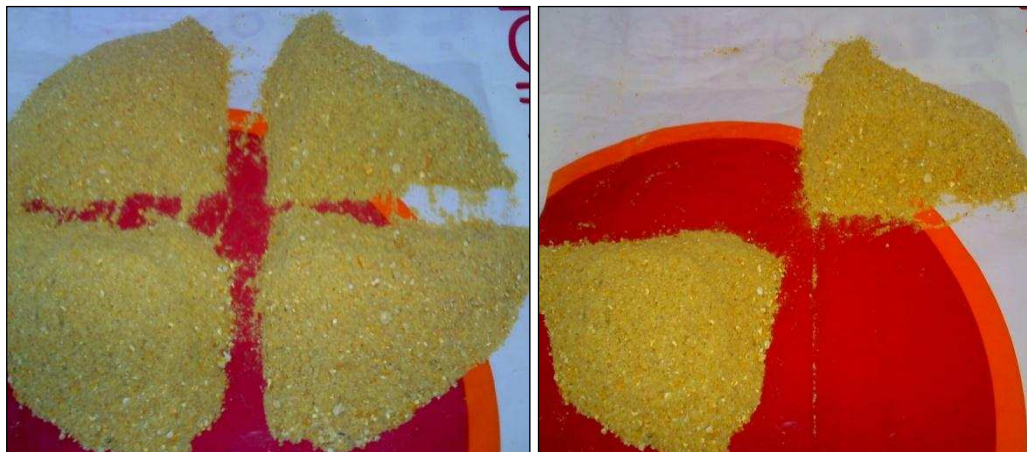
Figura 2.6. Procedimiento del método del cuarteo
