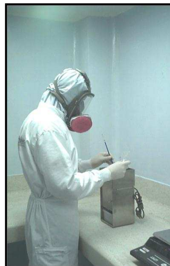
2.-Remover las partículas de hierro Del detector rotatorio.
