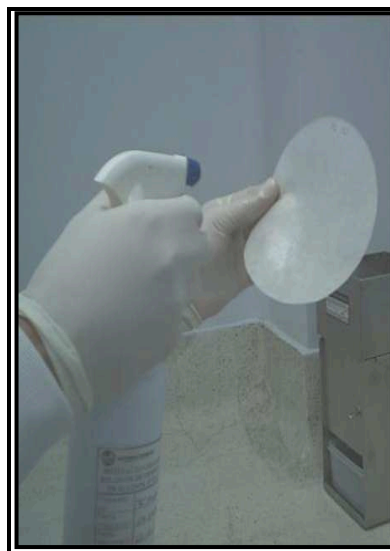
6.- Humedecer el papel filtro con etanol.
