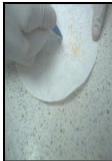
8.-Realizar el conteo de las partículas coloración producida en el papel filtro.
