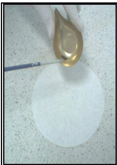
7.- Distribuir uniformemente las partículas de hierro sobre el papel filtro humedecido.
