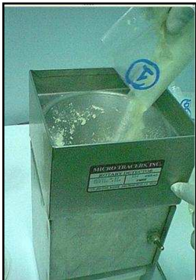
1.-Pasar la muestra por el detector rotatorio.
