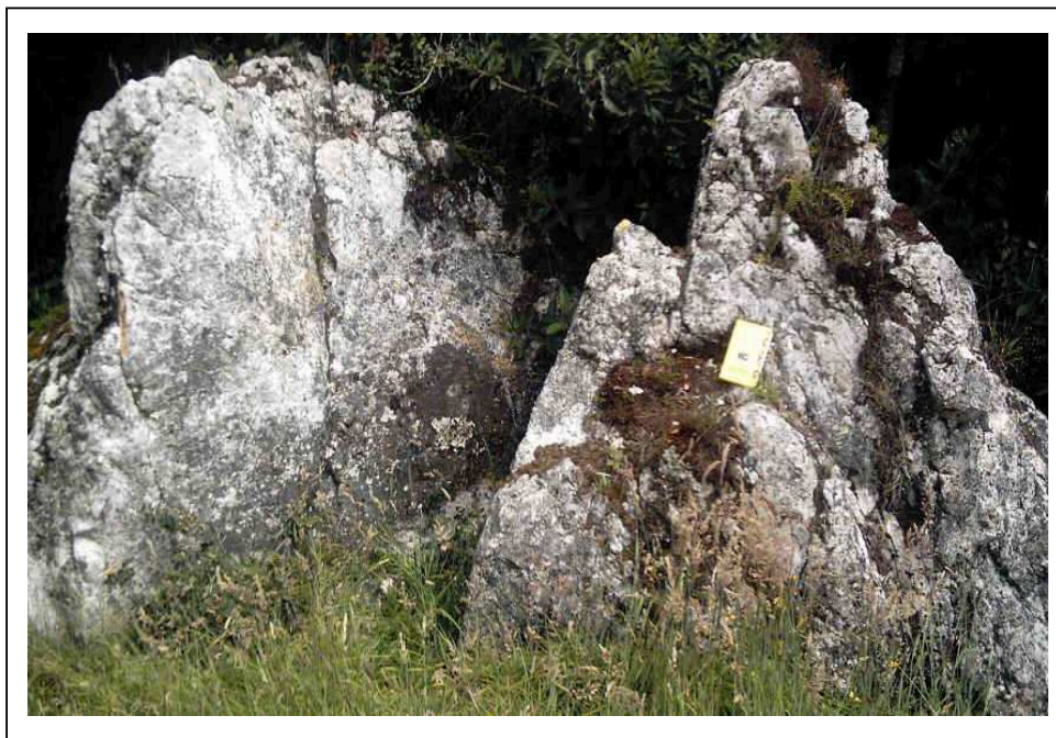
Foto 17.- Toba andesítica ( T^A ) del Grupo Saraguro completamente reemplazada por sílice. Composito de muestra M-CH-09 (UTM: 681283 E / 9652160 N).
