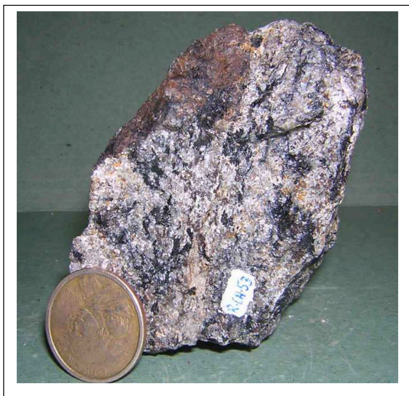
Foto 12.- Muestra M-CH-12 de brecha de cuarzo-turmalina en la granodiorita de Tuntún.
