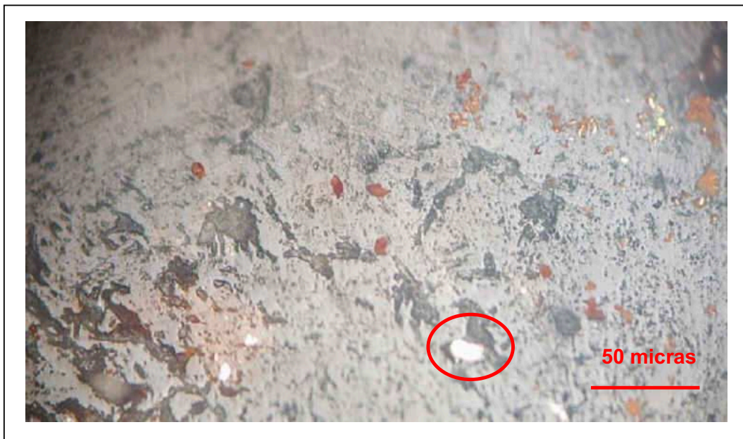
Foto 26.- Muestra 5516, donde se aprecia oro nativo fino en círculo rojo, hospedado en sílice calcedónico y hematita como puntos de color rojo.
