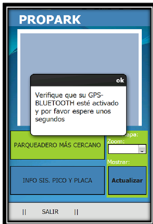
Figura 3-56. Mensaje de la aplicación si el GPS no está encendido
