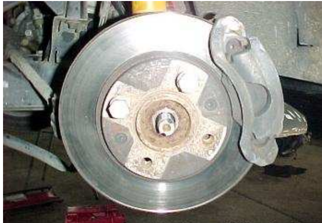
FIGURA 4.8: COLOCACIÓN DE LOS BULONES
