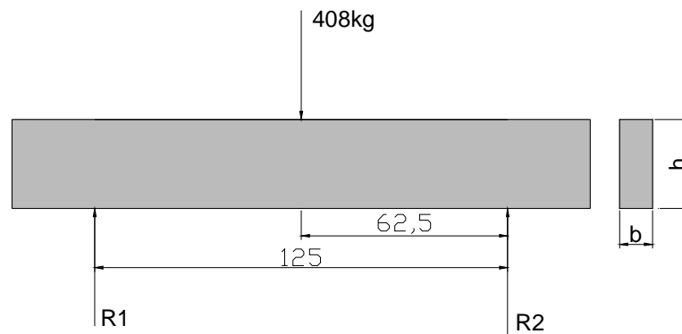
FIGURA 2.12: ESLABÓN CON TODA LA CARGA F=408 KG
