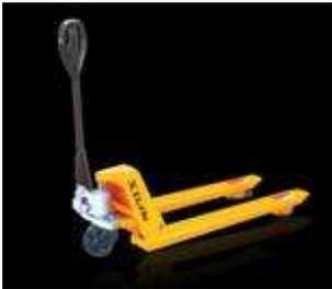
Patines hidráulicos con estructura de acero con ruedas delanteras y traseras de poliuretano; capacidad de carga: 1,000 kgs; horquillas: 1,220 x 685 mm (48" x 27"); ruedas de poliuretano (PSD-3000P); ruedas de carga tipo tándem; palanca de posiciones de 1,224 mm de alto; altura mínima: 85 mm (3.3"); altura máxima: 203 mm (8"); ancho de horquilla: 158 mm (6.25"); ancho del patín: 685 mm (27"); peso: 90 kgs. ; pintura: esmalte de alta resistencia.
