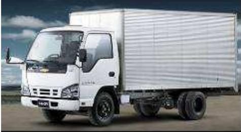
Camión NHR a diesel con capacidad de carga máxima de 2.115 kg; motor Isuzu de 2.8 litros de 95 hp y 3400 rpm con inyección directa y turbointercooler acoplado a una transmisión manual Isuzu de 5 velocidades; cinturones retráctiles de tres puntos, apoyacabezas, frenos de servicio hidráulicos de doble circuito servoasistidos. El camión será utilizado para retirar las Autopartes y realizar las entregas del producto, además de otras actividades que sean requeridas.
