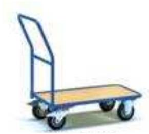
Carros de almacén de tubo de acero soldado, pintura lacada al horno; plataforma de madera contrachapada; 2 ruedas fijas y 2 orientables de caucho macizo; bujes con cojinetes de rodillos; capacidad 400 kg y frenos en ruedas orientables.
