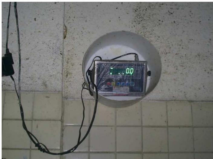
**Figura 14.** Fotografía de la balanza electrónica utilizada en el pesaje final de las medias y cuartos de canal.
