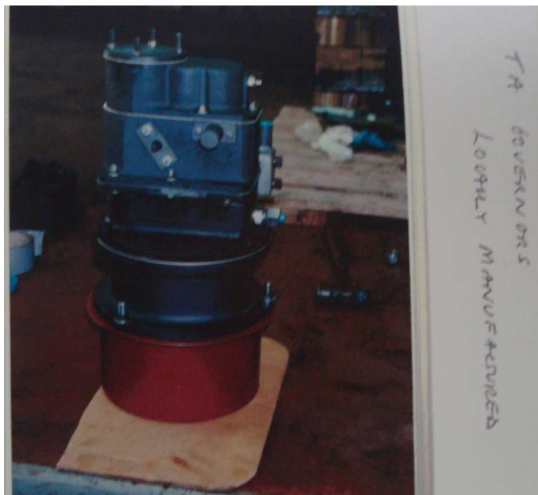
Figura 3.9 Regulador de Velocidad de la Turbina TA 1750
