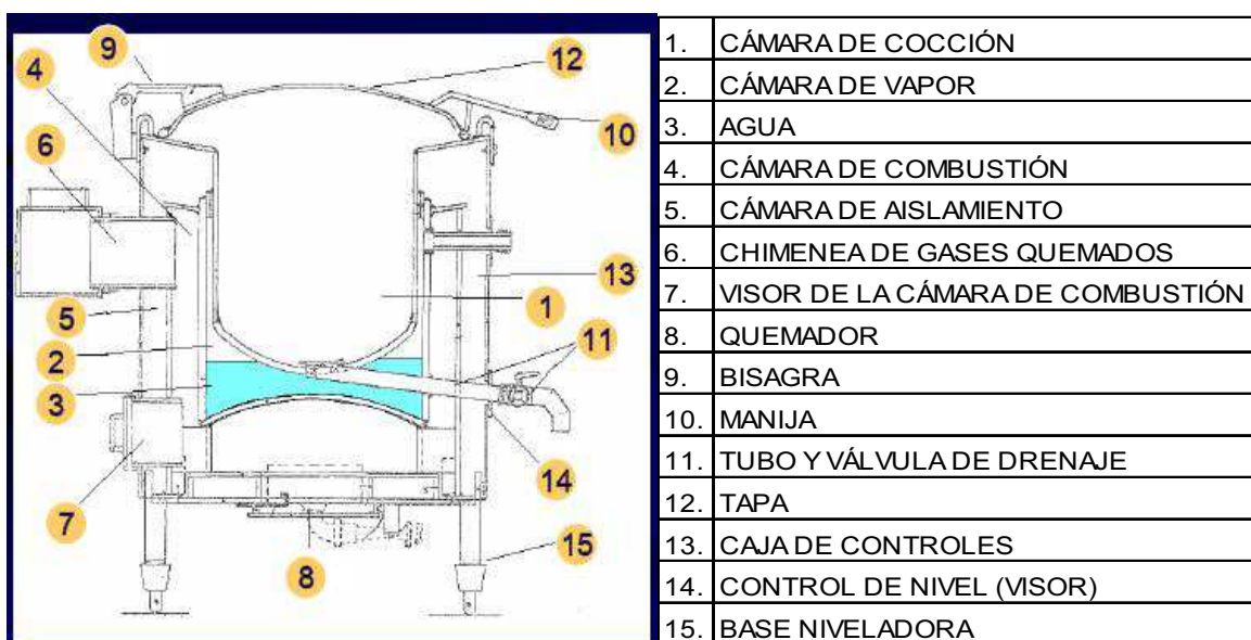
Figura 4. Marmita mezcladora para cocción de alimentos (Pallomaro, 2008)
