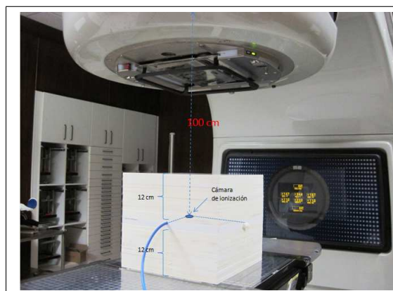
Figura 3.12: Fantoma de placas de poliestireno para realizar las pruebas clínicas generales.
