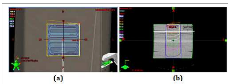
Figura 3.11: Esquema de un perfil de dosis para un campo de 15cm x15 cm con cuña física de 15°, (a) vista sagital y (b) vista transversal de las curvas de isodosis del campo. Imagen del sistema de planificación ECLIPSE
