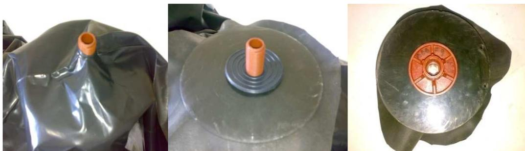
Colocar los tubos de PVC de 1 metro de longitud y 20-30 cm de diámetro en los extremos del práctico tubular. Estos deben ajustarse con la cinta de neumático.
