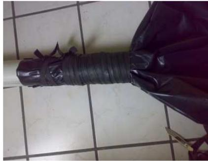
Realizar las conexiones respectivas con los tubos de PVC de 2 pulgadas, la T de PVC, la manguera hasta llegar a la válvula de cierre. No olvidar la válvula de seguridad con la botella plástica.
