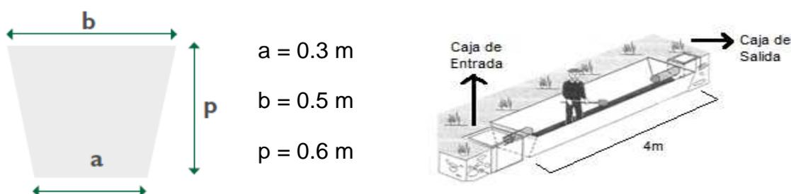
Estas medidas son aproximadas. La zanja debe evitar en lo posible derrumbes en sus paredes. Las paredes deben ser lo más lisas posibles. Para el recubrimiento de la zanja se puede adquirir el plástico como una geomembrana como se presenta a continuación:
