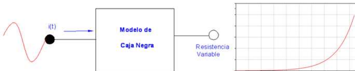
Figura 2.4 Esquema de modelo de “Caja Negra”
