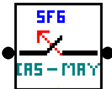
Figura 2.6 Icono representando un interruptor con tecnología del SF6, utilizando el modelo de arco eléctrico de Cassie y Mayr.
