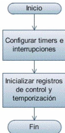
Figura 3.38. Diagrama de flujo del Programa para los Actuadores
