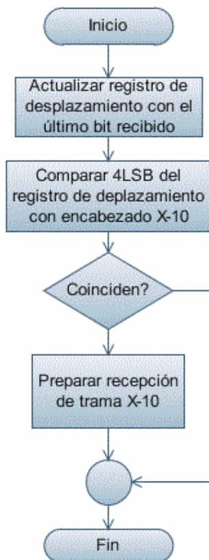
Figura 3.41. Diagrama de flujo para la identificación de encabezados X-10
