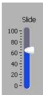
Figura 3.28. Control vertical que comanda las instrucciones Dim/Bright
