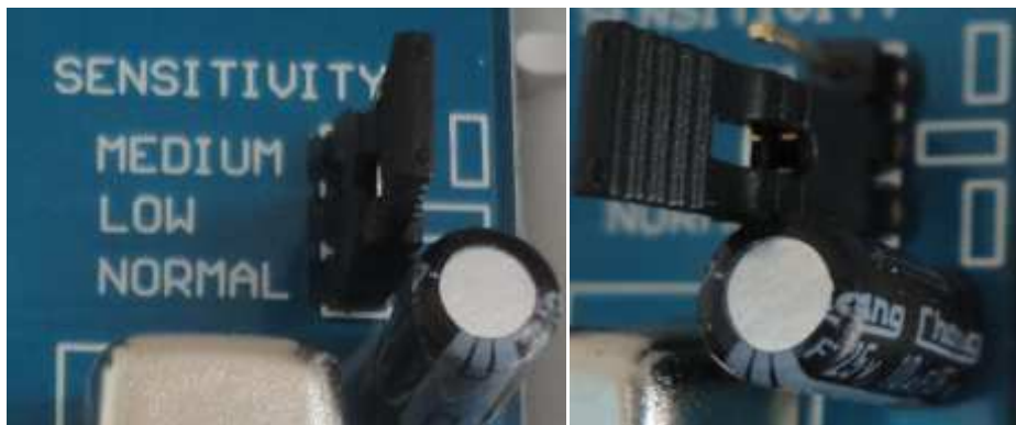
Figura 3-2. Selección de la sensibilidad en el sensor
