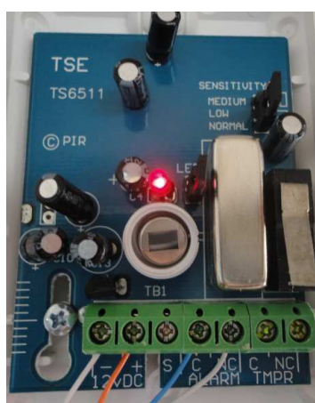
Figura 3-1. Conexión del sensor de presencia.
