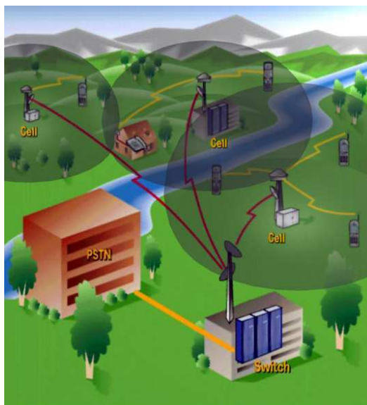
Figura 1-11. Diagrama del funcionamiento de la telefonía móvil 14
