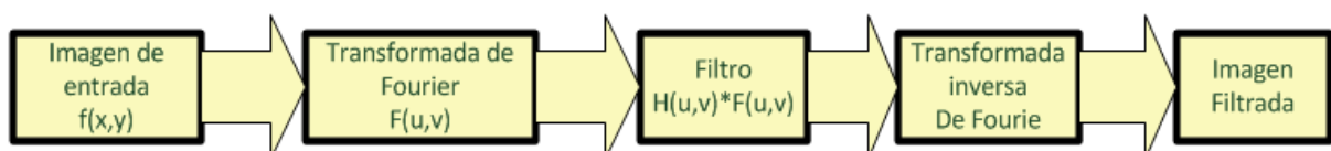
Figura 1.17 Etapas del procesamiento de imágenes en el dominio de la frecuencia (Tomado de [12]).
