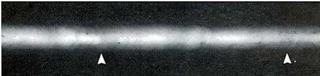
Figura 2. 35 Imagen radiográfica de la presencia de poros dispersos en la junta soldada.
