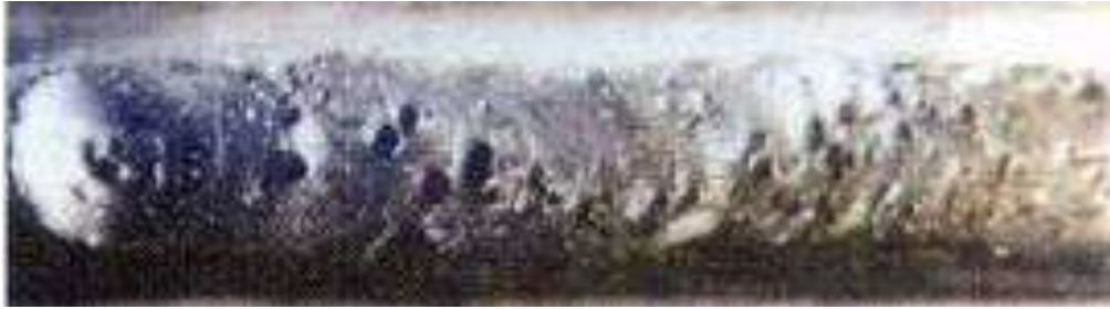
Figura 2. 18 Poros regulares en la superficie del cordón.
