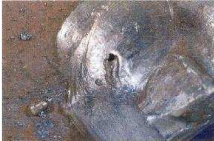
Figura 2. 16 Poros alargados al inicio del cordón.
