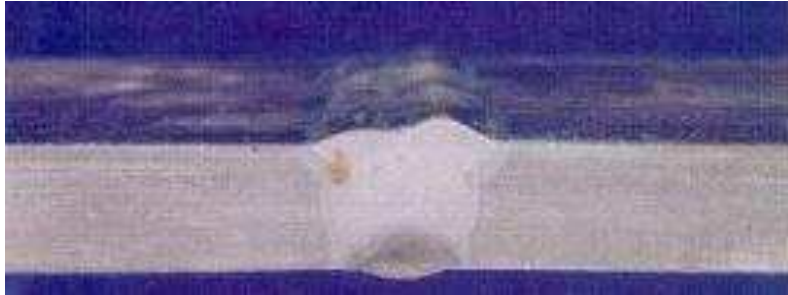
Figura 2. 11 Sobreespesor en la parte superior del cordón.
