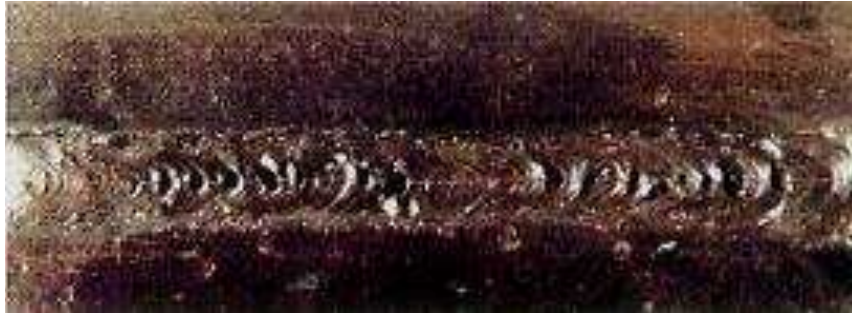
Figura 2. 26 Fisuras debidas al arranque del arco.
