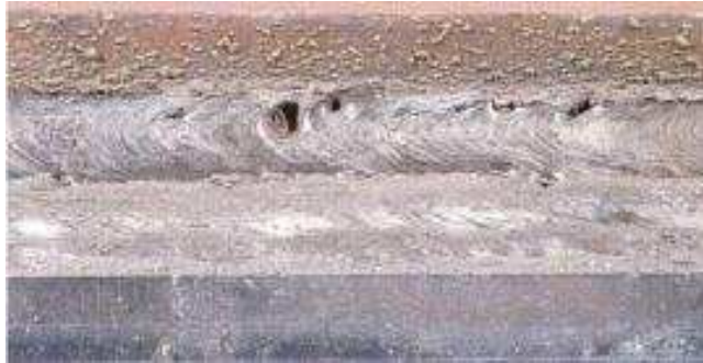
Figura 2. 15 Inclusiones superficiales de escoria.
