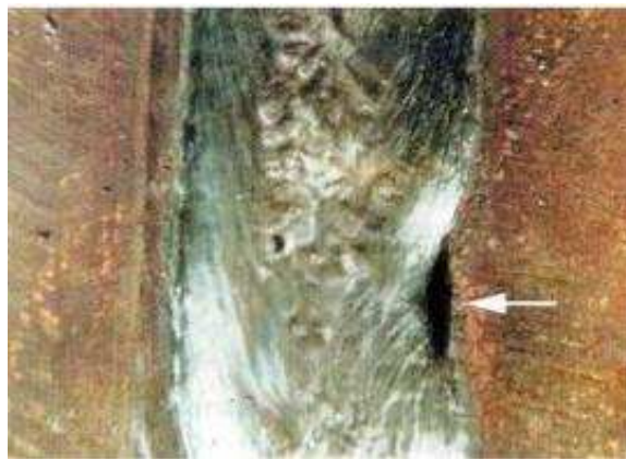
Figura 2. 12 Falta de fusión al borde del cordón.
