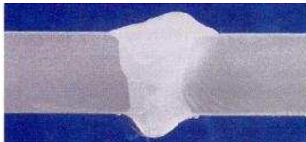
Figura 2. 10 Sobreepesor de ambos lados de la junta.
