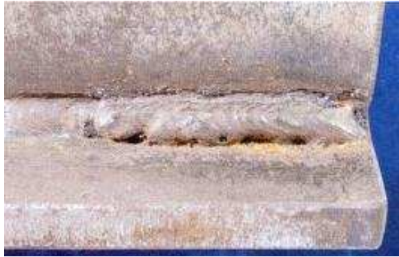
Figura 2. 13 Solapado en el cordón de soldadura.
