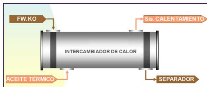
FIGURA 3.6 TRATADOR TÉRMICO O INTERCAMBIADOR DE CALOR
