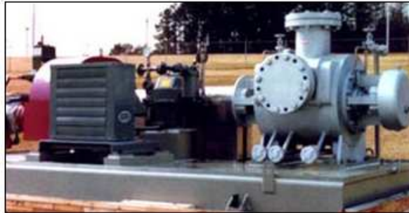
FIGURA 2.29 BOMBA DE TORNILLO MULTIFÁSICA
