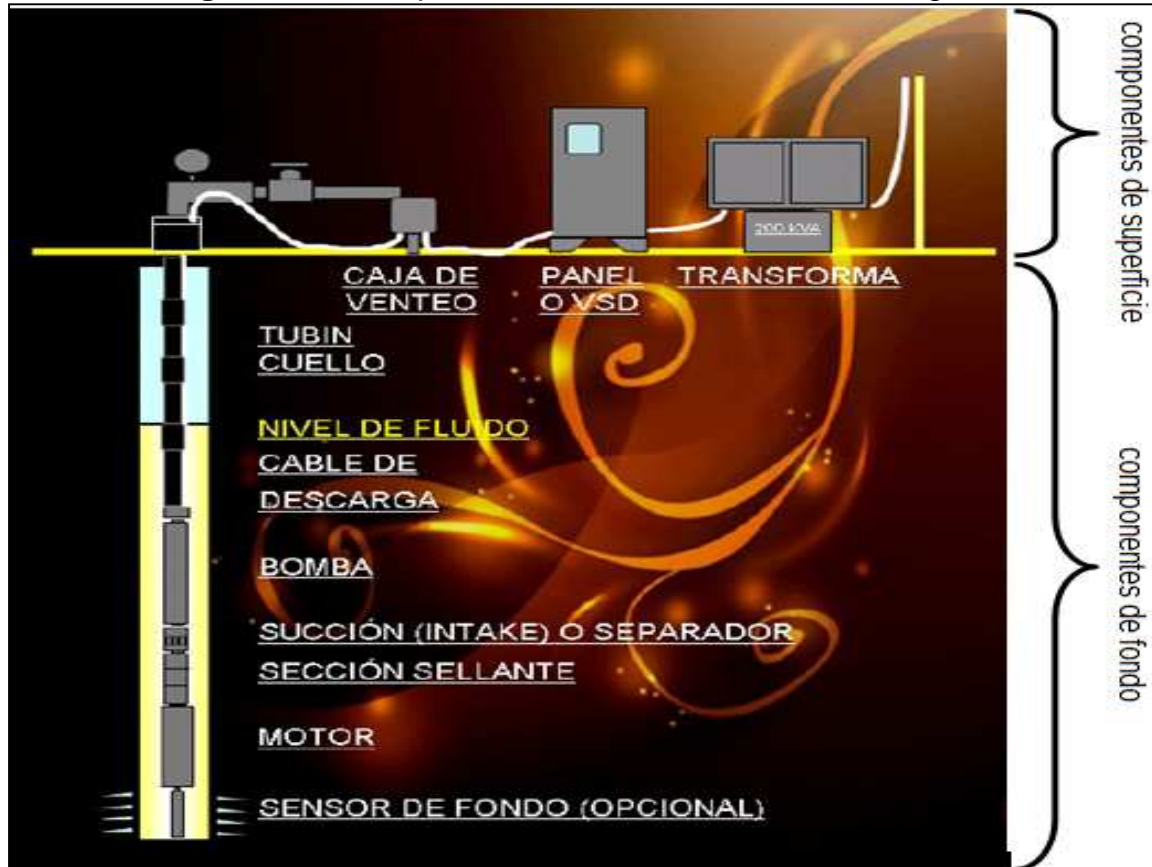
Figura 2.5: Componentes del Bombeo Electrosumergible
