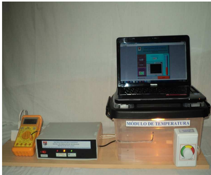
Figura 4.4 Implementación del módulo de monitoreo de temperatura mediante enlace Bluetooth
