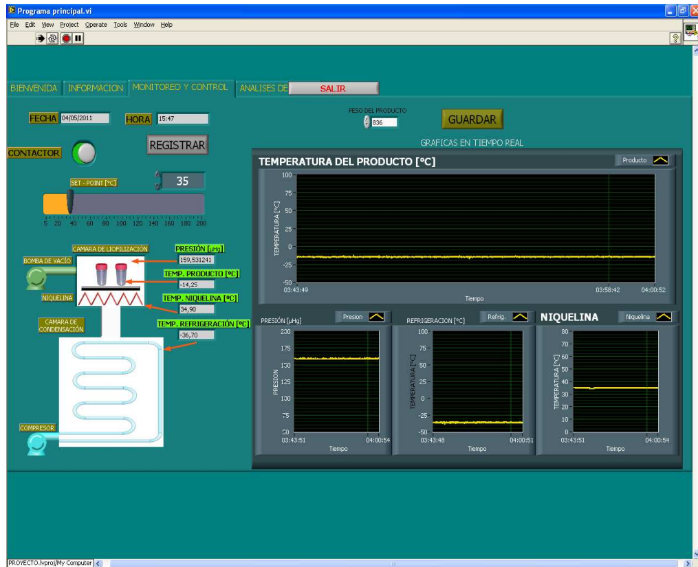
Figura 4.9 Registro de temperatura de la HMI.
