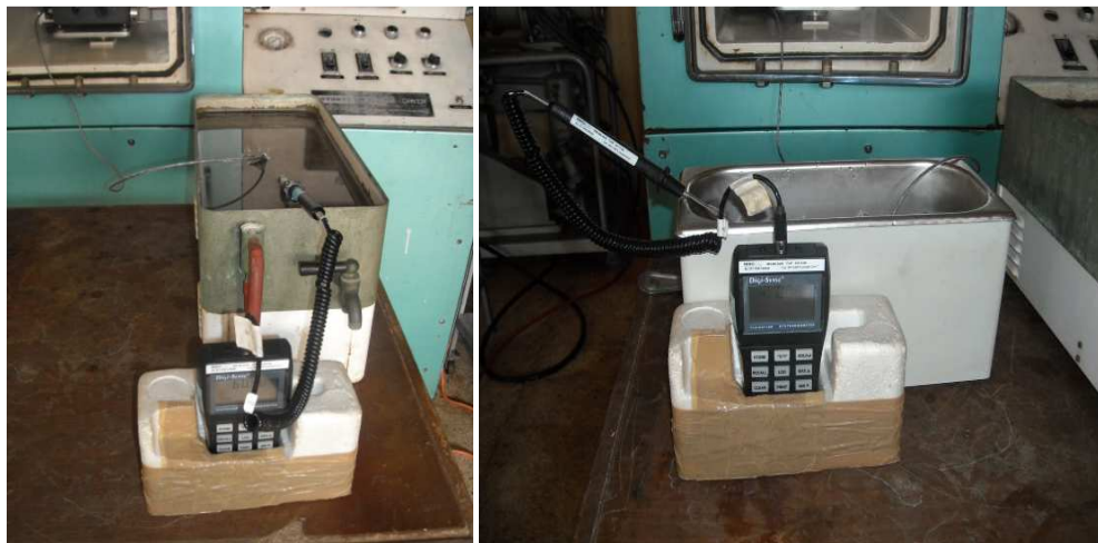
Figura 4.1 Elemento Patrón de temperatura y baño termostático.
