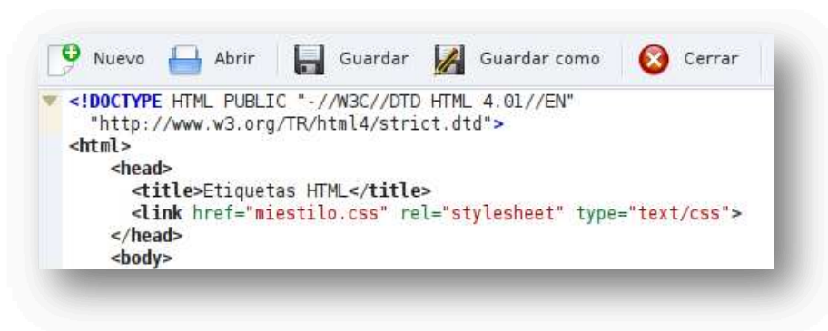
Figura 1.45 Ejemplo de inserción de una hoja de estilo en un documento HTML.
