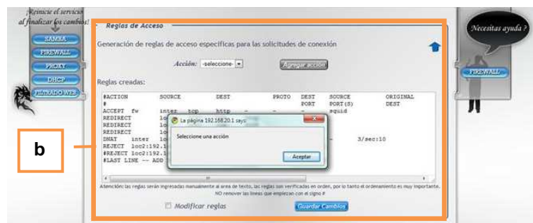
Figura 3.26 Interfaz - Generación de Reglas de Acceso específicas.
