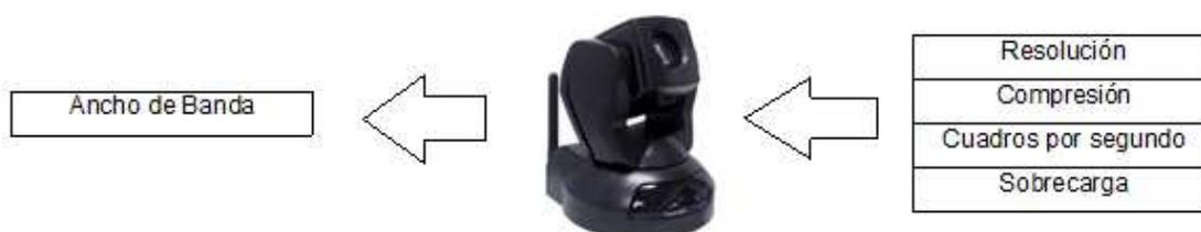
Figura 2. 9 Parámetros que determinan el cálculo aproximado del Ancho de Banda en una cámara IP.
