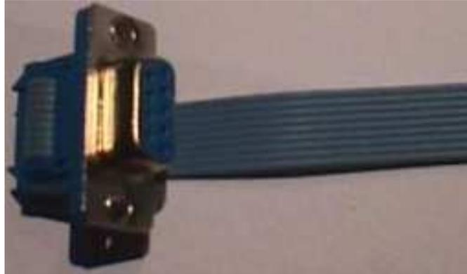
*Figura 1. 42 Conector db9 hembra para bus*
