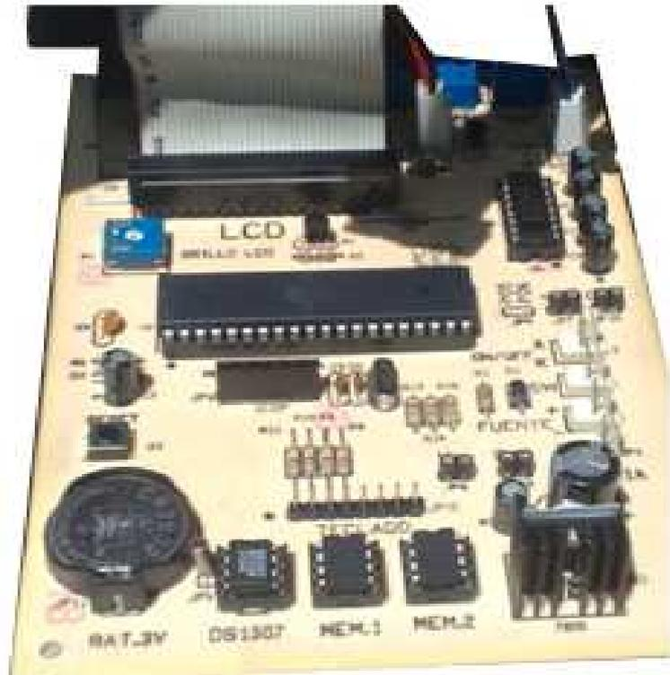
*Figura 3. 3 Elementos Soldados en la placa*
