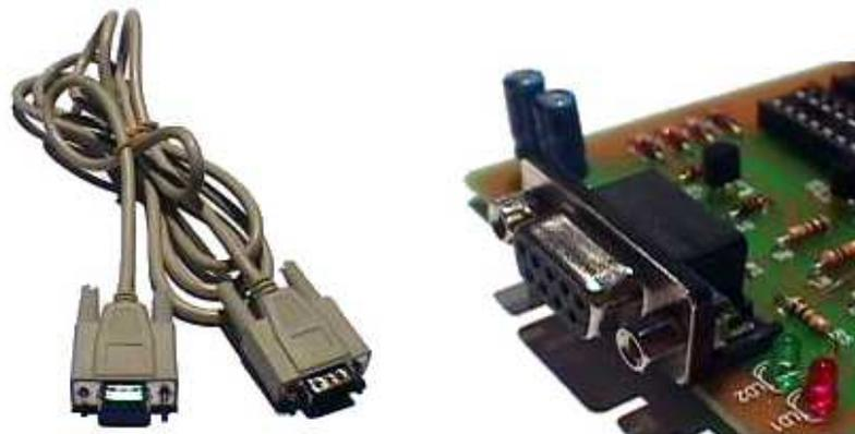
Figura 1. 40 Cable serie macho-hembra no cruzado y conector hembra db9 para circuito impreso
