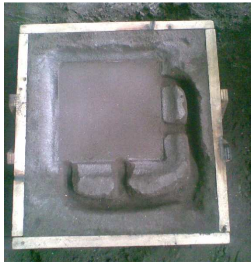
Figura 4.1.- Moldeo de placa en arena verde
