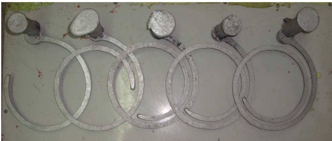
Figura 3.8.- Espirales de fluidez colados en las pruebas preliminares.
