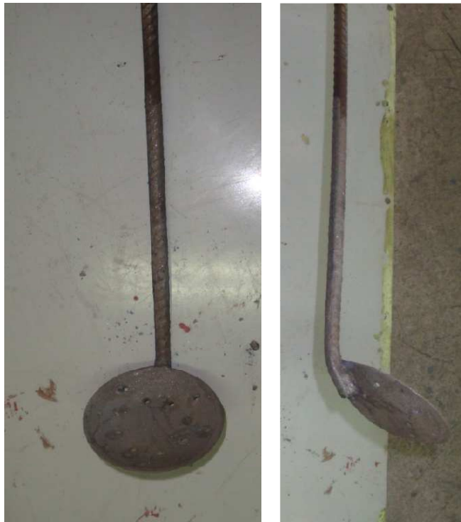
Figura 3.1.- Escoriador de acero inoxidable
