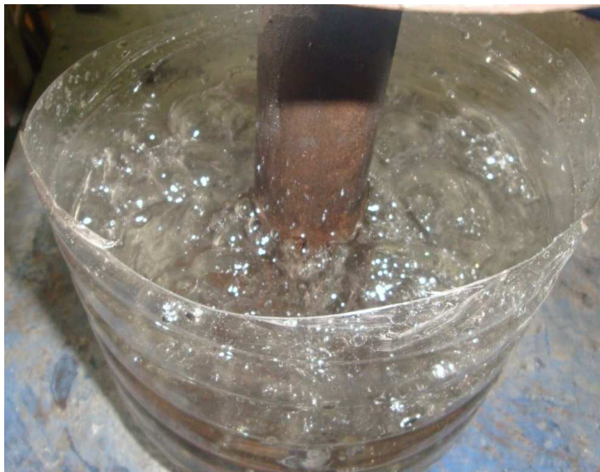
Figura 3.4.- Pruebas del tamaño de burbujas del primer diseño de la lanza de Argón.
