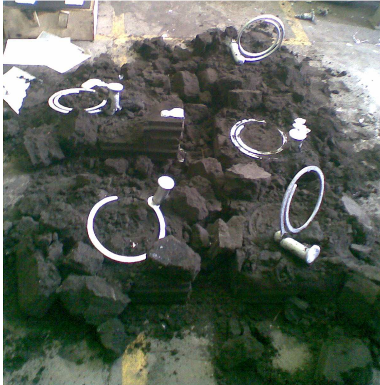
Figura 4.6a.- Colado de los espirales de fluidez
