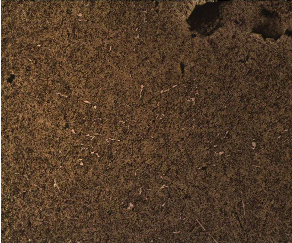
Figura 4.11.- Micrografías de la probeta 4, tratadas a 300°C tiempo int, enfriado al aire
