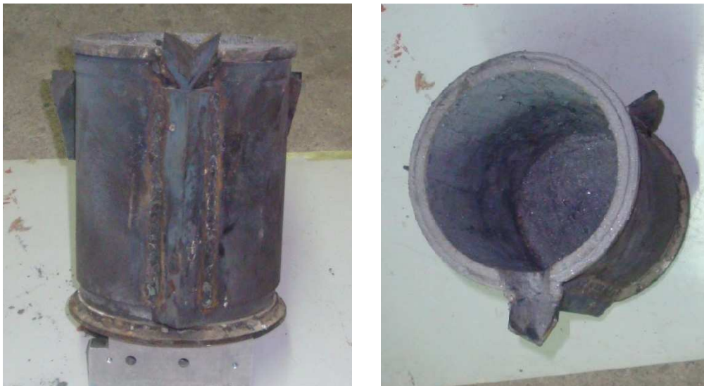
Figura 3.2.- Crisol de Hierro fundido
