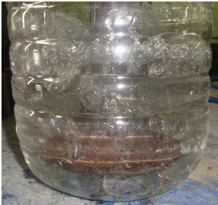
Figura 3.5.- Pruebas del tamaño de burbujas del segundo diseño de la lanza de Argón.
