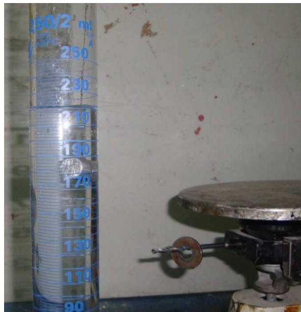
Figura 3.6.- Pruebas para encontrar la densidad relativa
