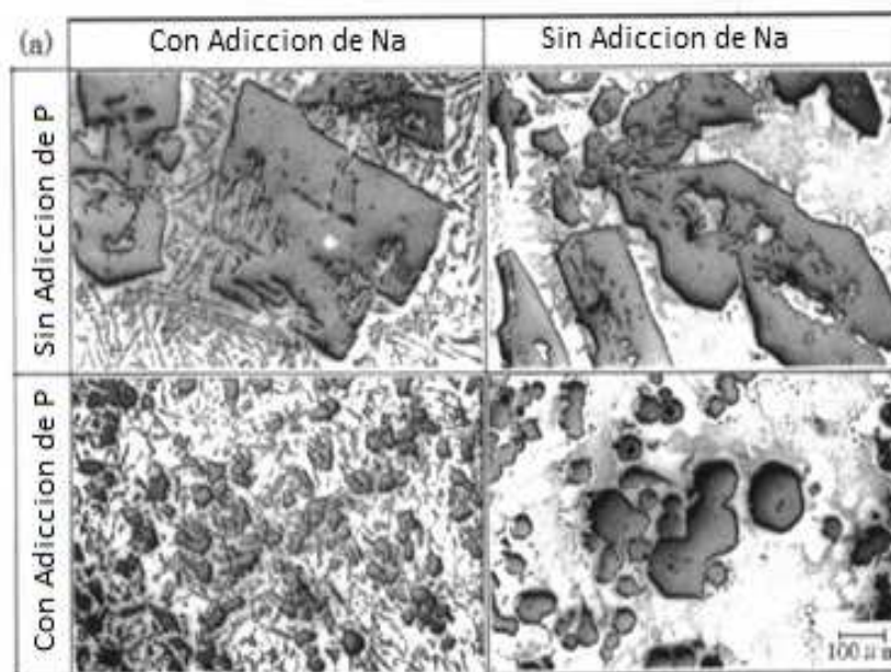
Figura 2.41.- Comparación de microestructuras en lingotes fabricados de AlSi, con y sin afinamiento de grano [Totten 2 ].
