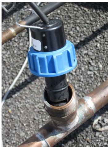
Figura 2.5 Vistas del dispositivo para montaje del sensor de Flujo FP5600. Fotografía tomada en el LEAEE de la FIM (28-04-2011)
