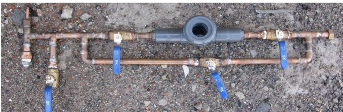
Figura 2.6 Vistas del dispositivo para montaje del sensor de Conductividad SC4A. Fotografía tomada en el LEAEE de la FIM (28-04-2011)
