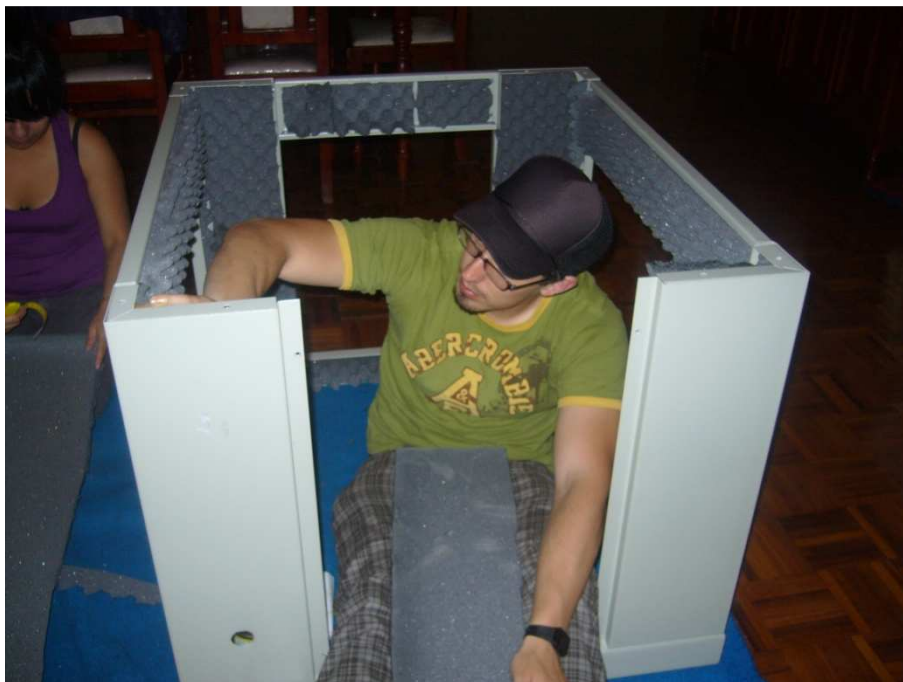
Figura N° 4.8 Colocación material aislante
