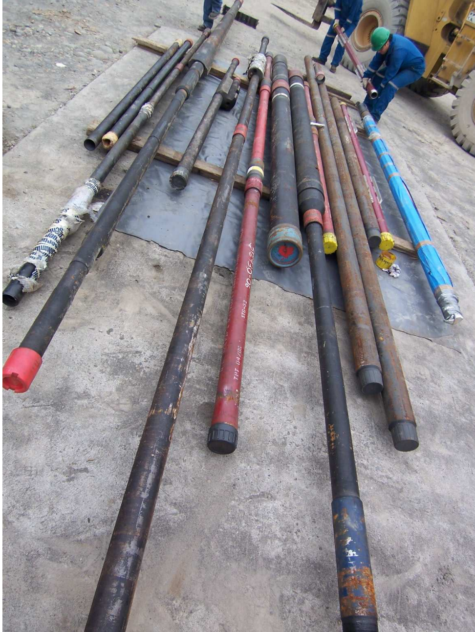
Subensambles de la completación doble concentrada
