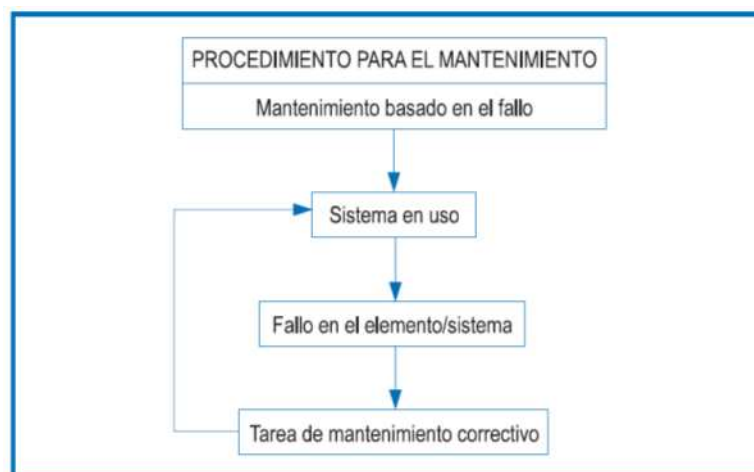
Figura 3-9 Algoritmo para una política de mantenimiento basado en el fallo
