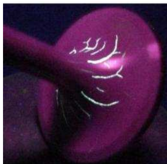
Figura 3-2 Líquidos penetrantes aplicados en una válvula
