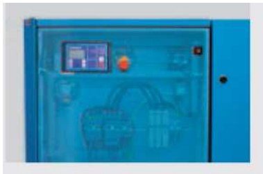
Figura 2-19 Armario de distribución eléctrica
