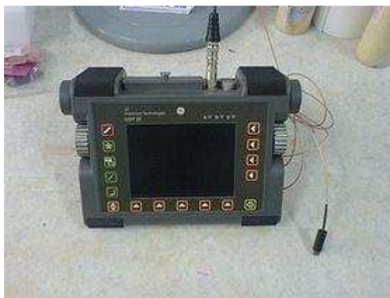
Figura 3-4 Equipo portátil de inspección por ultrasonido
