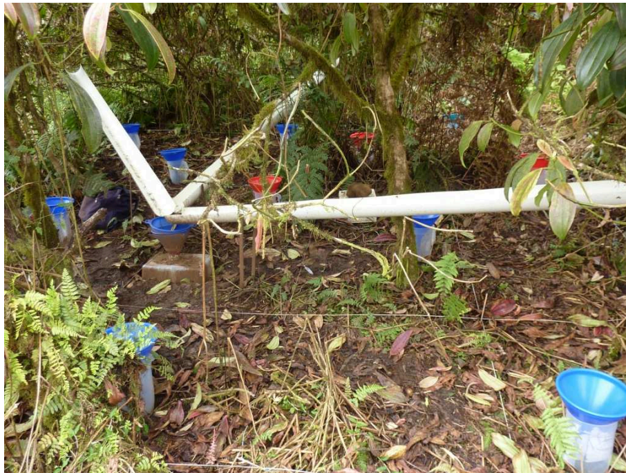
Figura 4.8: Imagen del conjunto de colectores y canales en la parcela de estudio de Media Luna.
