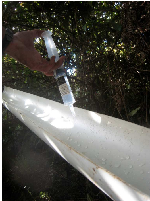
Figura A.5: Detalle de la calibración de los canales con una jeringa.
