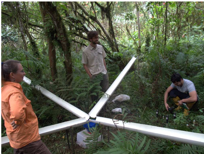
Figura A.3: Canales de recolección de la Estación Villacís. Nótese la caja que cubre el pluviómetro automático.
