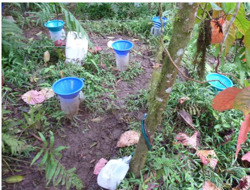
Figura A.6: Parcela de medición con la grilla para medir la posición de los colectores. Nótese alrededor del tronco la manguera de recolección del stemflow que termina en un tanque.
