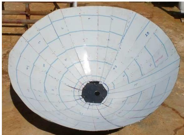
Figura 5.10.- Reflector parabólico.
