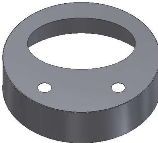
*Figura 4.3.- Cámara de enfriamiento del fluido de trabajo.*
