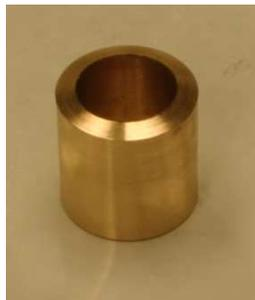
*Figura 3.38.- Bocín para el bulón y la biela.*
