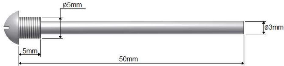
*Figura 4.14.- Guía del foco caliente.*
