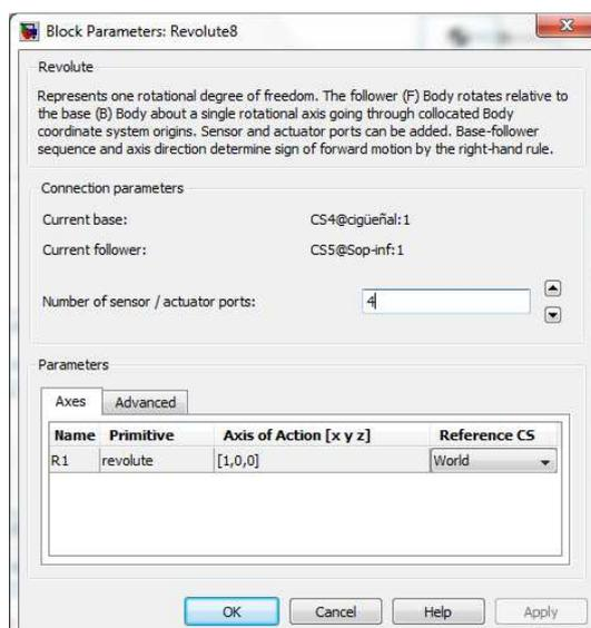
Figura 3.68.- Ventana de configuración de la junta rotatoria.
