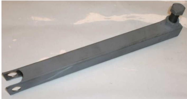
*Figura 5.17.- Segundo brazo de la junta prismática.*
