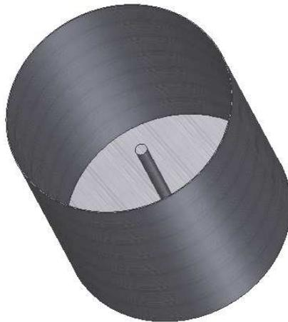
*Figura 4.15.- Cámara de calentamiento del fluido de trabajo (diámetro interior 72mm, longitud 80mm).*
