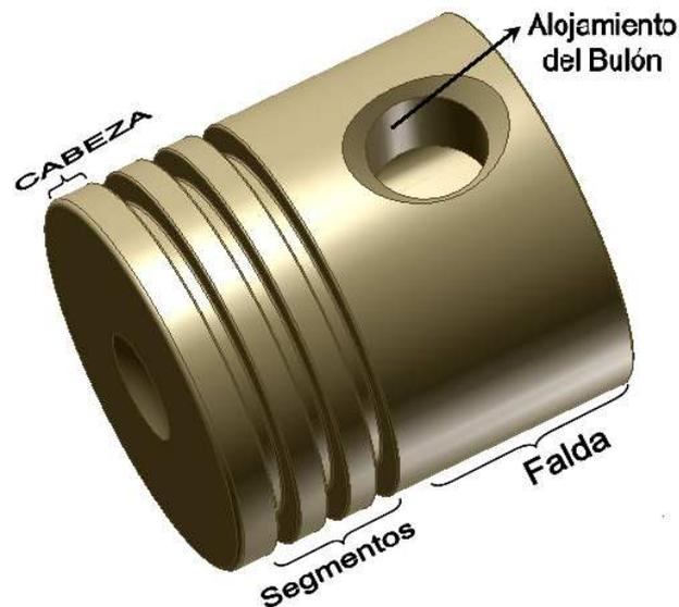
*Figura 3.2.- Partes principales del pistón.*
