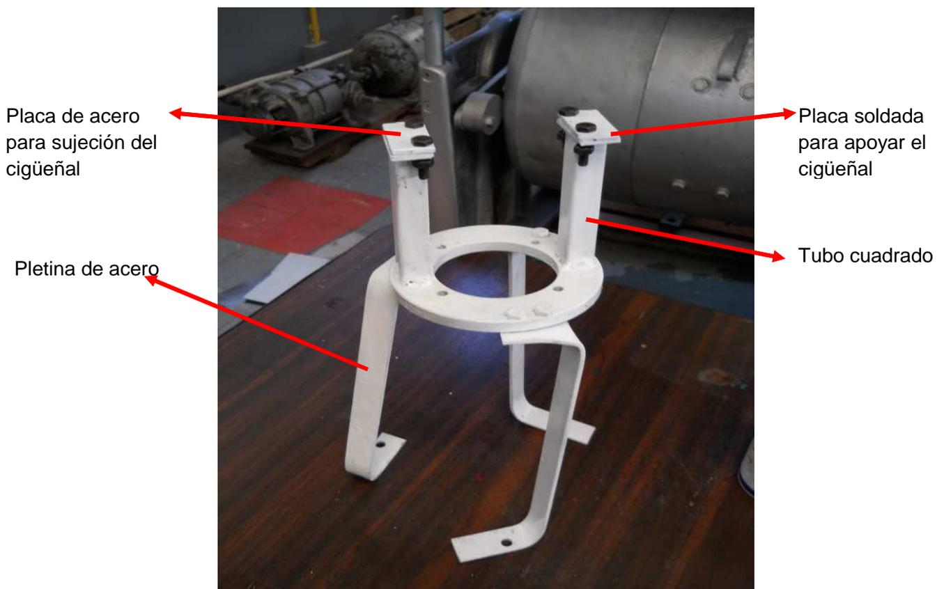
*Figura 4.27.- Soporte del motor Stirling gamma.*
