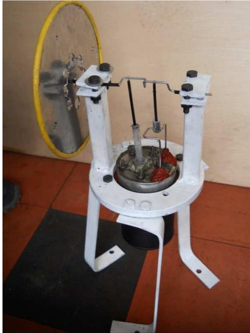
*Figura 4.31.- motor Stirling tipo gamma.*
