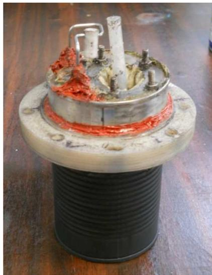
*Figura 4.30.- Acoplamiento del cilindro de presión y sus elementos.*
