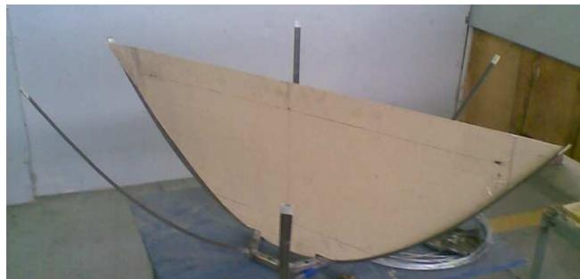
*Figura 5.6.- Pletinas de soporte para dar la forma básica al reflector.*
