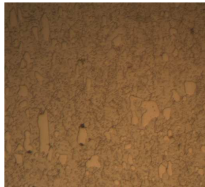
Figura 4-25: Metalografías del acero K100, probeta templada. Nital 2%, a) 100x, b) 500x.
