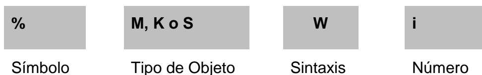
Figura 3-3: Formato de direccionamiento de objetos de palabras. 17
