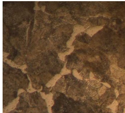
Figura 4-18: Metalografías del acero 1045 probeta testigo. Nital 2%, a) 100x, b) 500x.
