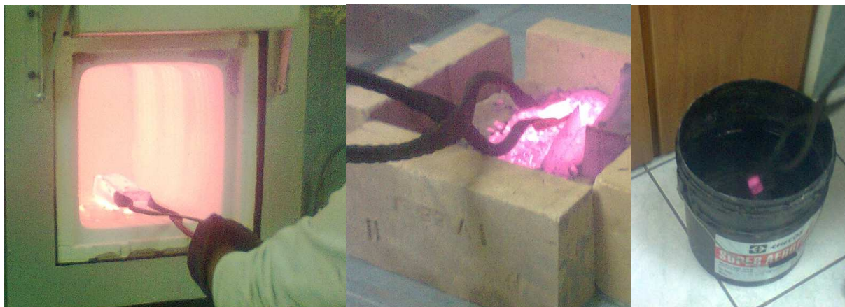
Figura 4-10: Proceso de templado de las probetas en diferentes medios.
