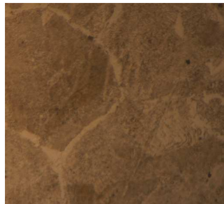
Figura 4-19: Metalografías del acero 1045, probeta recocida. Nital 2%, a) 100x, b) 500x
