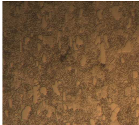
Figura 4-24: Metalografías del acero K100, probeta testigo. Nital 2%, a) 100x, b) 500x.
