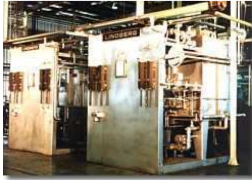
Figura 1-21: Hornos generadores de Atmósferas, Endotérmicas y Exotérmicas.
