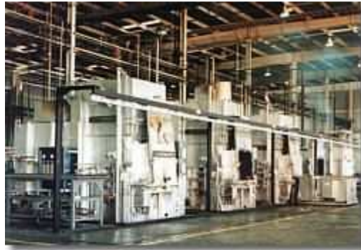
Figura 1-18: Horno Batch a gas para temple integral.
