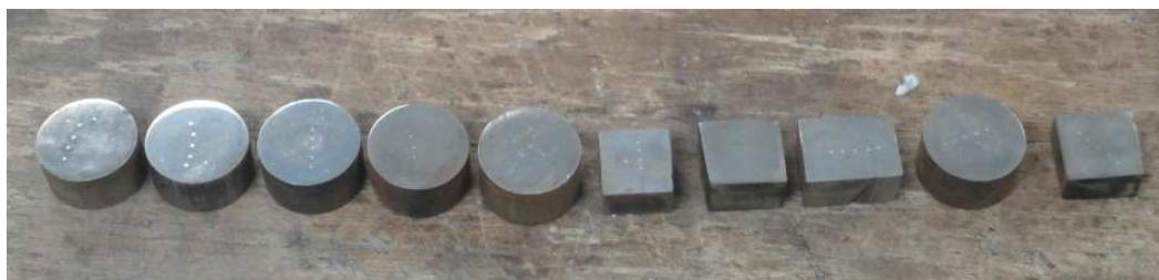
Figura 4-3: Probetas testigo y probeta elaboradas para someterlas a diversos tratamientos térmicos.
