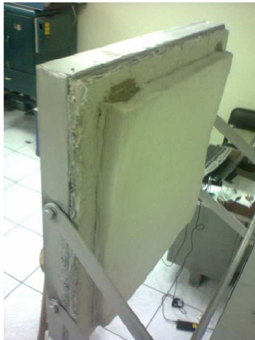
Figura 2-4: Puerta del Horno reforzada con manta refractaria.
