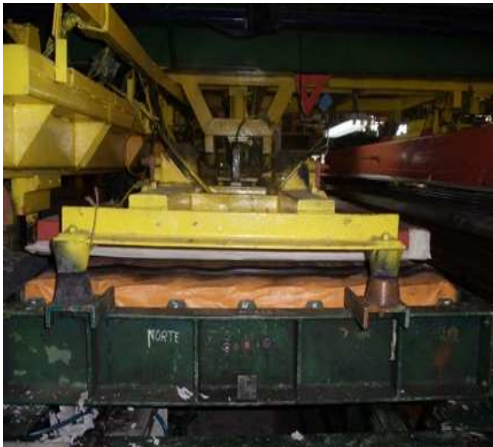
Figura 2.23 Pórtico 2 vista posterior, ventosa molde sobre banco de ondulación abierto
