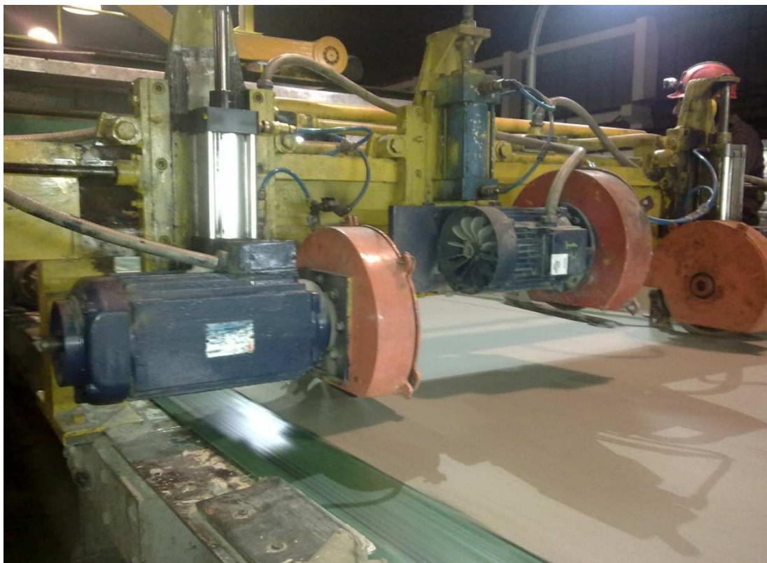
Figura 2.19 Cuchillas longitudinales del pórtico 2, pórtico que cuenta con la opción de fabricación de dos combinaciones, una es solamente las cuchillas de los extremos (como se observa en la fotografía) o la combinación de las tres cuchillas al mismo tiempo.
