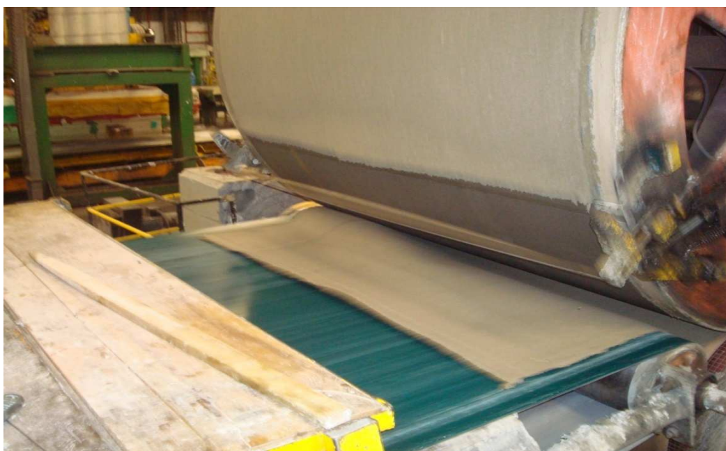
Figura 2.11 Rodo y corte de la pasta.
