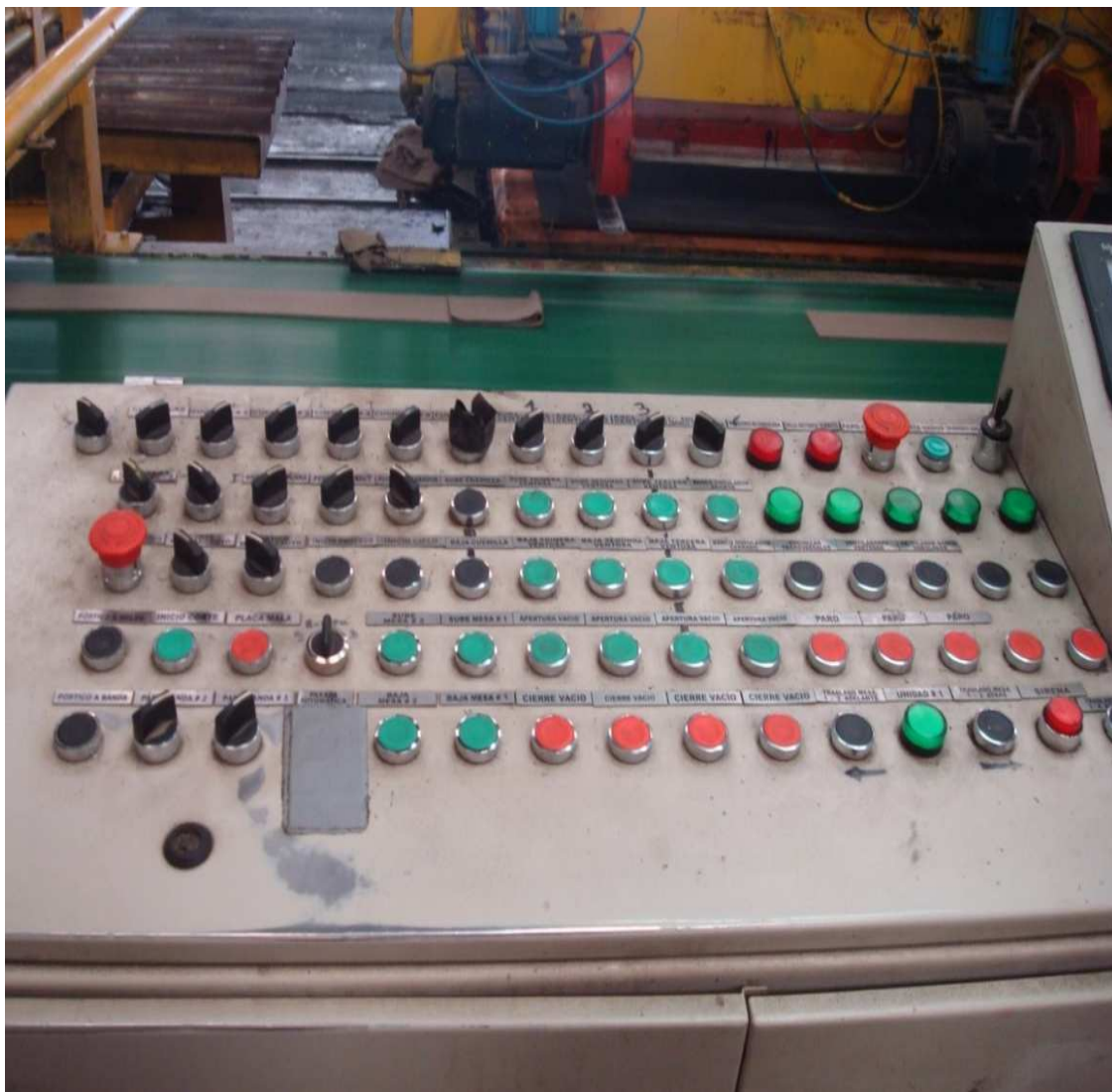
Figura 2.18 Botonera pórtico 2, cada botón y selector cuenta con su nombre, se visualizan los paros de emergencia con pulsador tipo seta.
