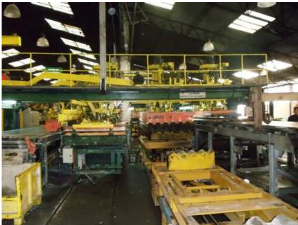
Figura 2.24 Pórtico 2 vista posterior, ventosas abajo, sobre el lado molde
