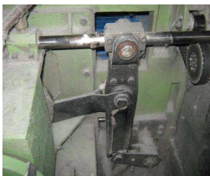
MECANISMO BIELA- MANIVELA PARA EL RECORRIDO DEL GUÍA-MECHAS
