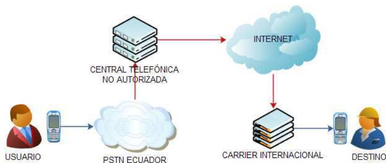
Figura 1.18. Diagrama de un “bypass” que procesa llamadas salientes
