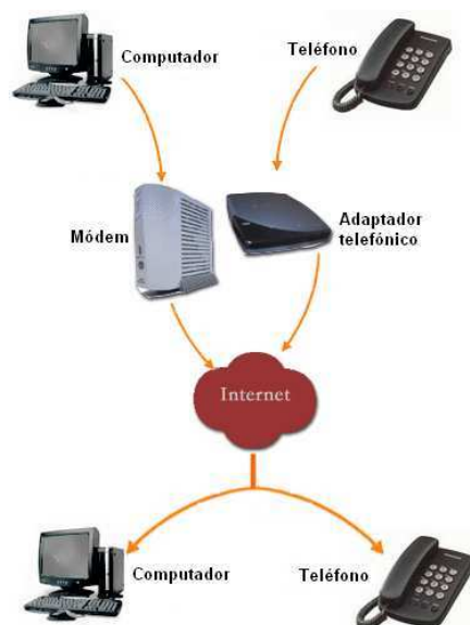
Figura 1.5. Sistema que utiliza VoIP [39]
