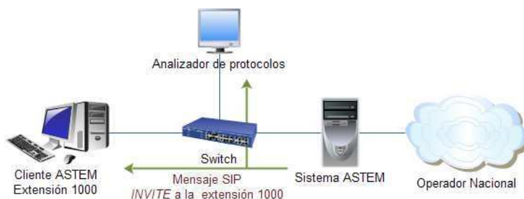
Figura 1.46. Diagrama de los equipos utilizados en este escenario
