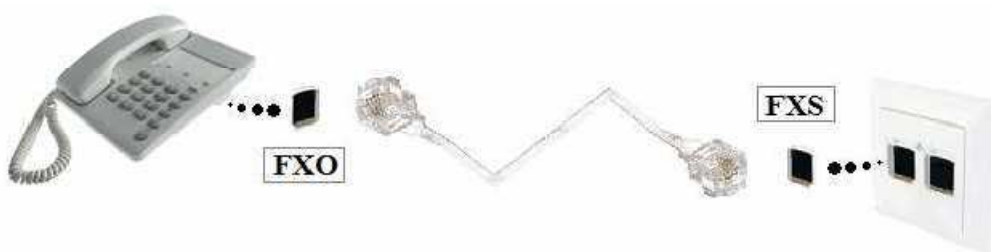
Figura 1.2. Puertos FXS y FXO en el lado del abonado [49]
