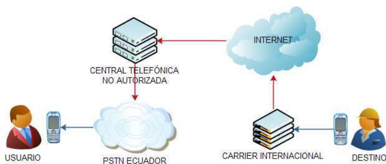
Figura 1.17. Diagrama de un “bypass” que procesa llamadas entrantes
