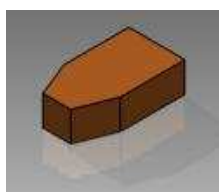
Figura 4.2 Esquema de la aproximación de la forma del ajonjolí para el cálculo de su volumen (Fuente: Propia)
