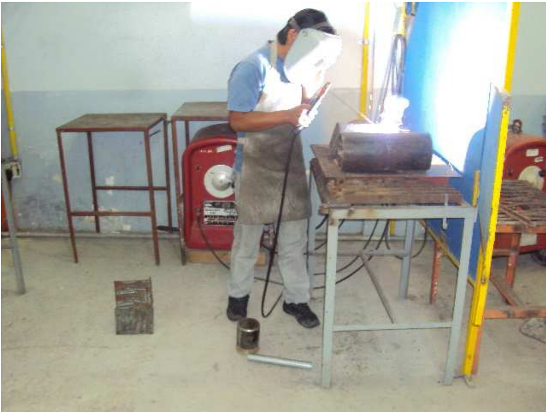
Foto F.2. Proceso de soldadura del cuerpo del hydram.
