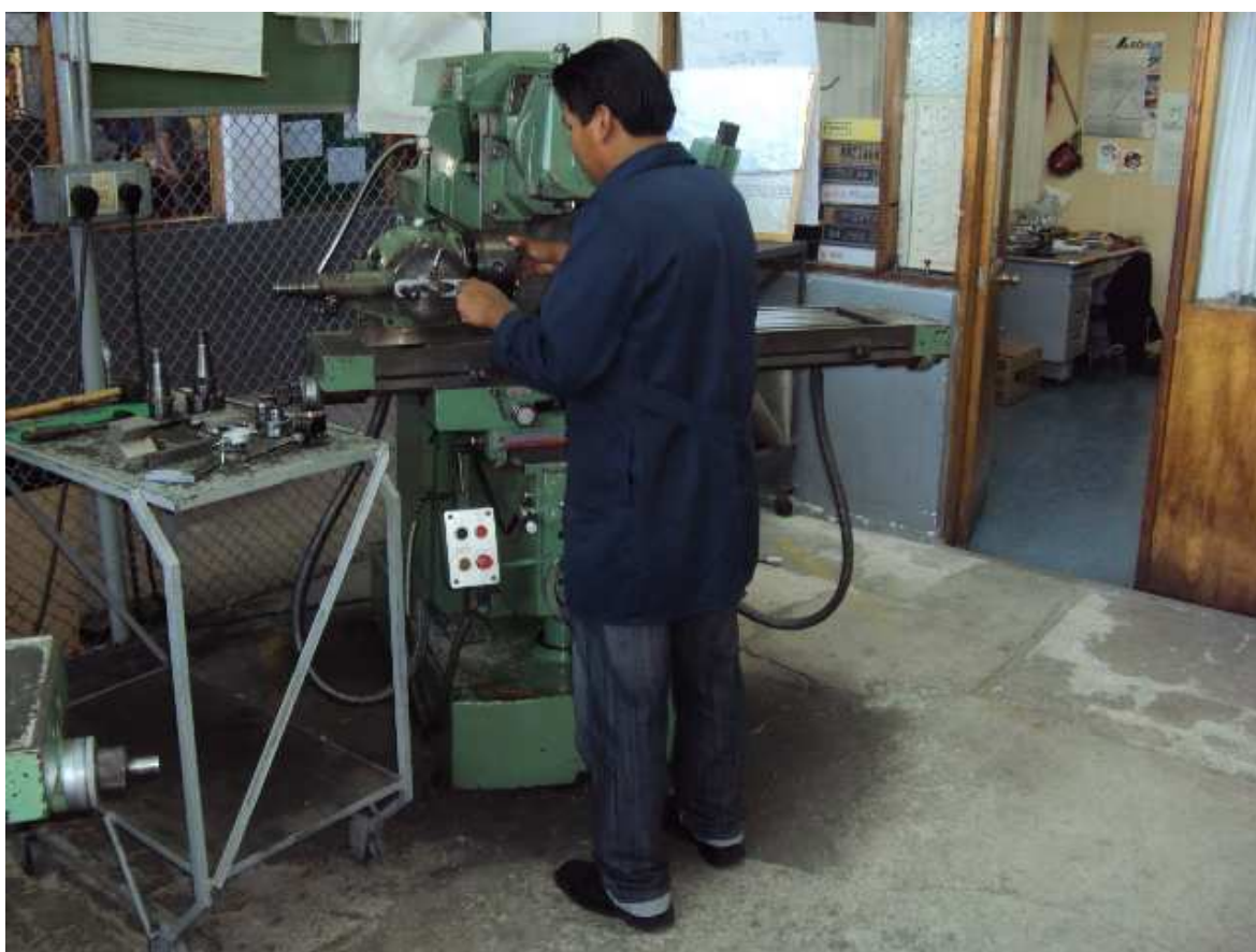
Foto F.3. Manufactura del plato de servicio (fresado).
