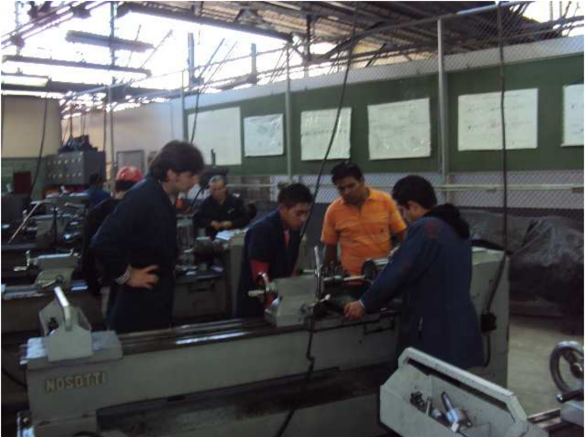
Foto F.5. Torneado del vástago de regulación.
