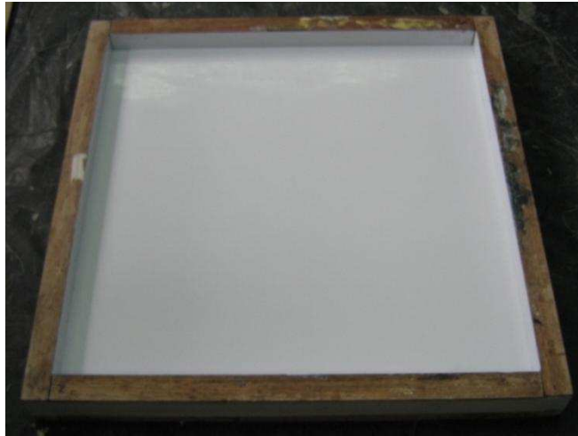
Figura 2.15. Molde macho-hembra de madera usado en la fabricación del prototipo.
