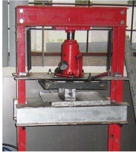
Figura 2.7. Prensa hidráulica de 12 toneladas de capacidad utilizada para el moldeo y distancia entre columnas de 66 cm.
