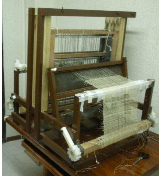
Figura 2.12. Telar manual usado para tejer fibras de abacá.
