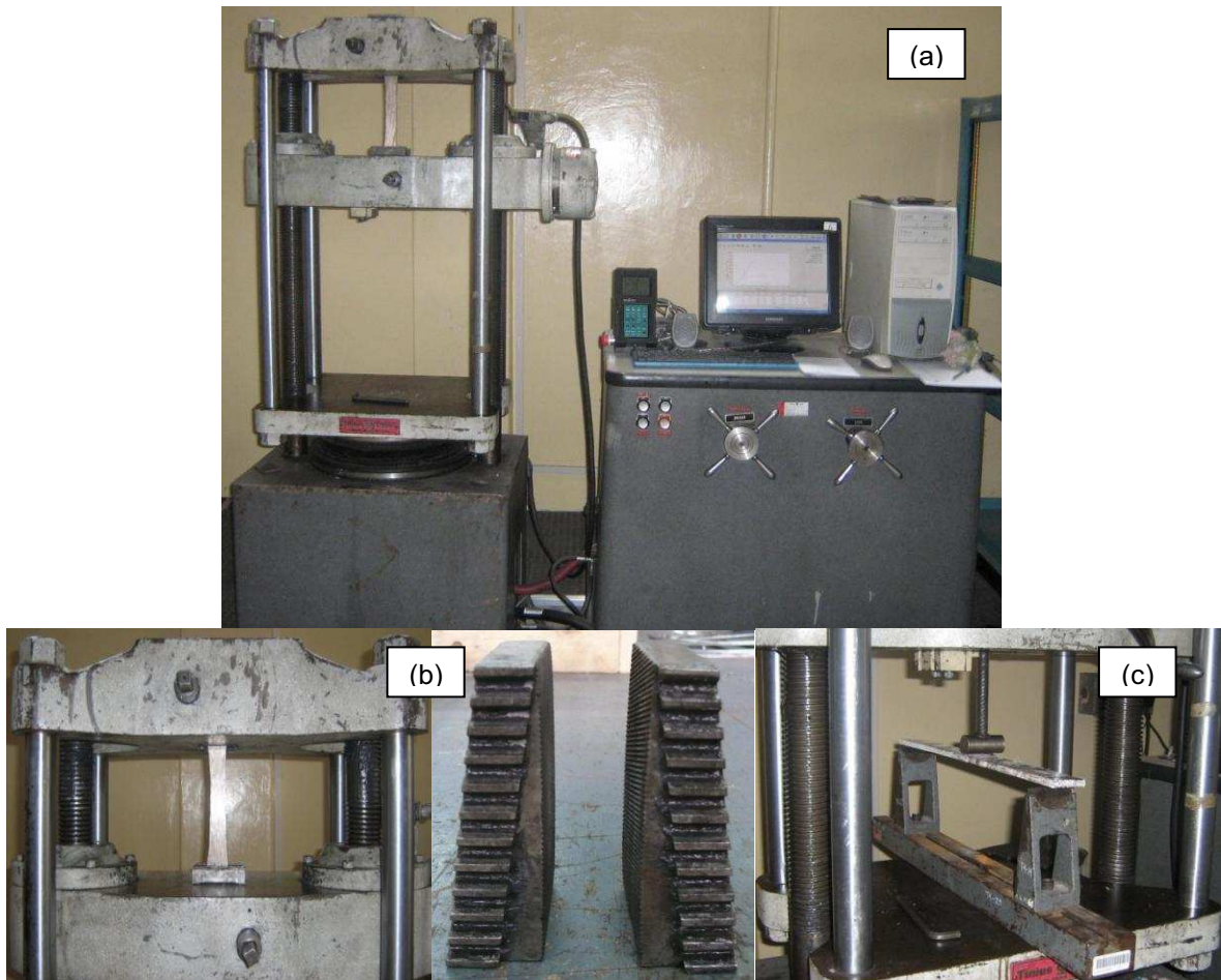
Figura 2.17. (a) Máquina universal de ensayos Tinius Olsen modelo Súper L. (b) Mordazas Cuneiformes. (c) Set de flexión a tres puntos.
