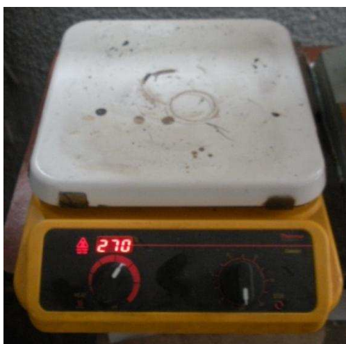
Figura 2.11. Estufa Thermo Scientific modelo Cimarec.
