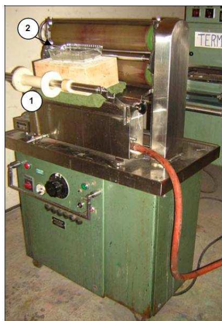
Figura 2.9. Foulard Ernst Benz LEV 5007 2R con sus adaptaciones. (1) Bobina de alimentación. (2) Caja de encolado. [Pontón, 2009]
