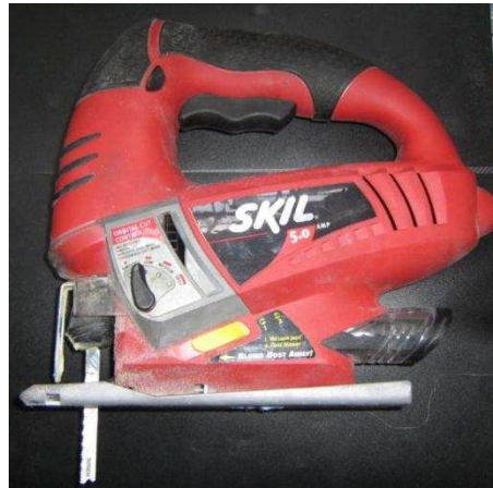
Figura 2.16. Caladora Skill modelo 4390 de 600 W de potencia.
