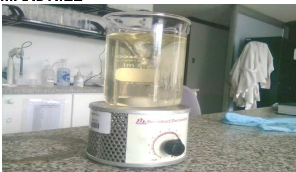
FIGURA 3.1: AGITADOR MAGNETICO CON MEZCLA DE GLYMAX Y MAXDRILL
