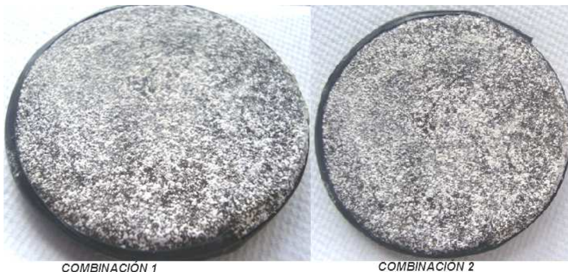
FIGURA 4.19: CORES EDY C-005 DESPUÉS DE LA PRUEBA PPT
