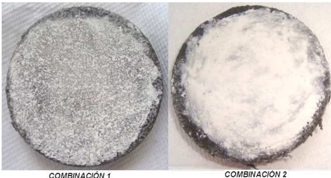
FIGURA 4.18: CORES EDY A-054 DESPUÉS DE LA PRUEBA PPT
