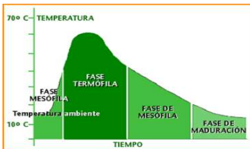
Figura 1.1 Fases en el proceso de compostaje en función de la T vs. t
