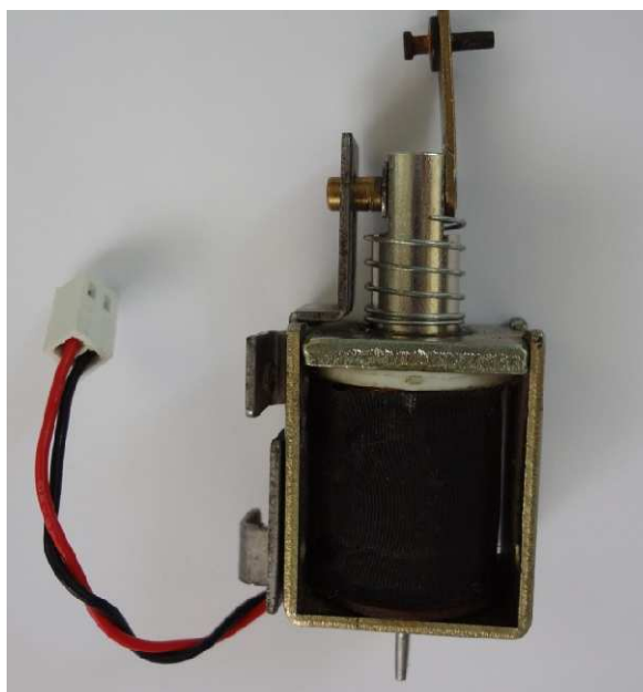
Figura 2.7 Detalle de solenoide acoplado al punzón
