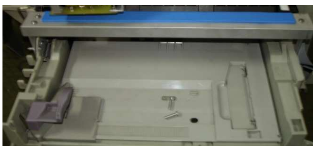
Figura 2.5 Base de impresión adaptada en la carcasa de la impresora
