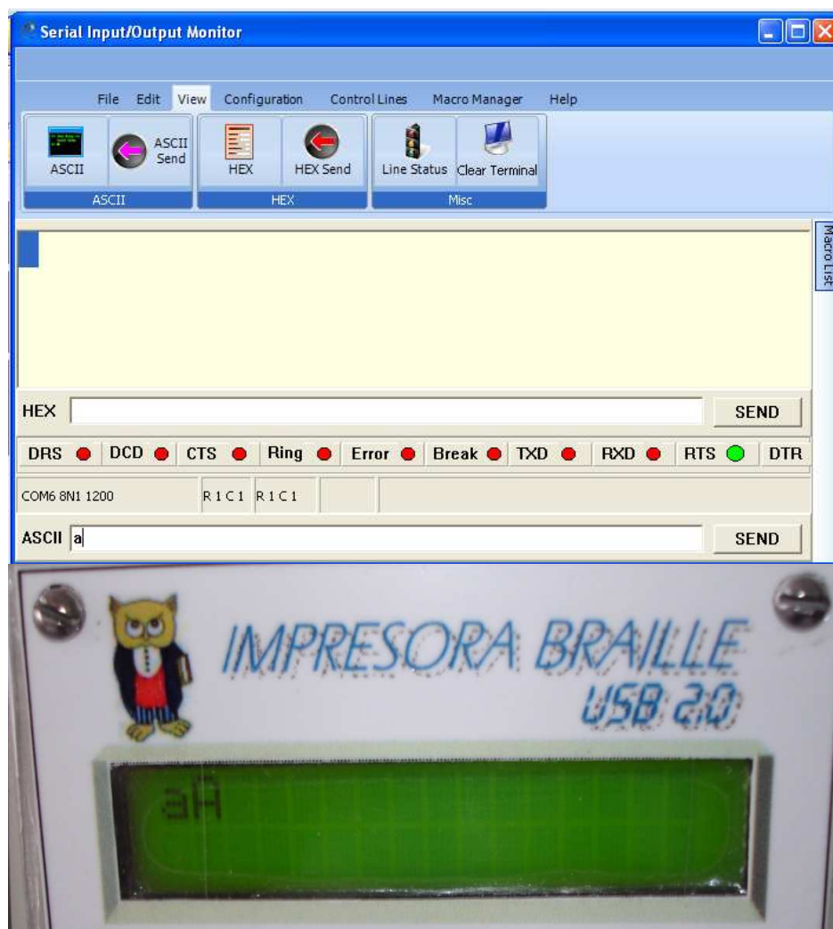
Figura 4.9 Recepción de caracteres en el módulo
