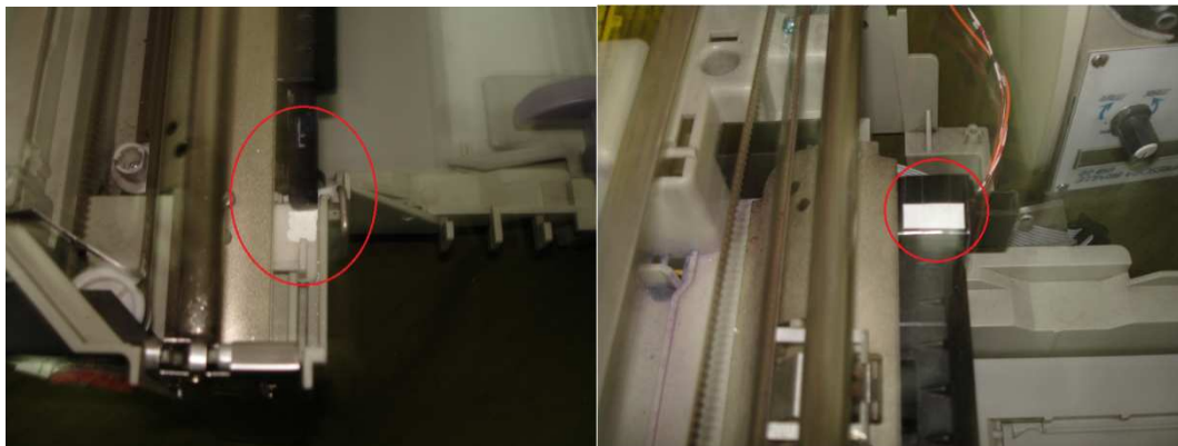
Figura 2.32 Marcas de contraste para el fin de carrera óptico GP2S40
