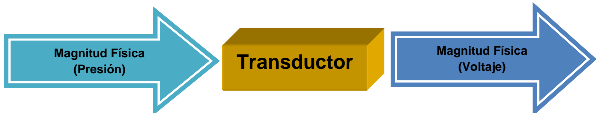
Fig. 1.9: Conversión de un transductor.
