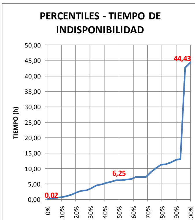
Figura 4.A.6: Estadística Descriptiva y Percentiles de Tiempo de indisponibilidad por falla - L/T 230 kV.
