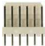
Figura E.9 Conector tipo Molex macho y Conector J1 de la Spartan-3E Starter Kit Board.
