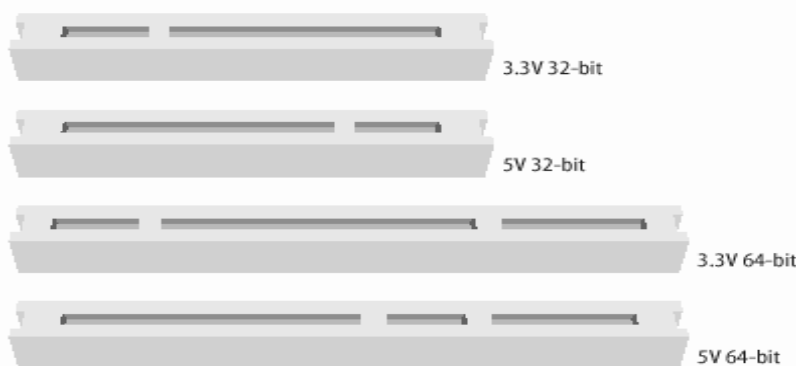
Figura 2.29 Identificación visual de slots PCI 54
