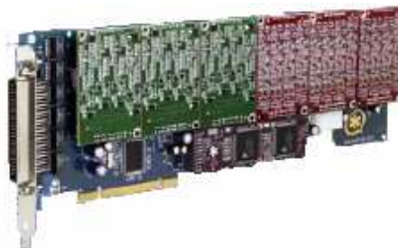
Figura 2.31 Tarjeta para puertos FXS/FXO TDM 2400E con 3 módulos X400M (rojos) y tres módulos S400M (verdes) 59
