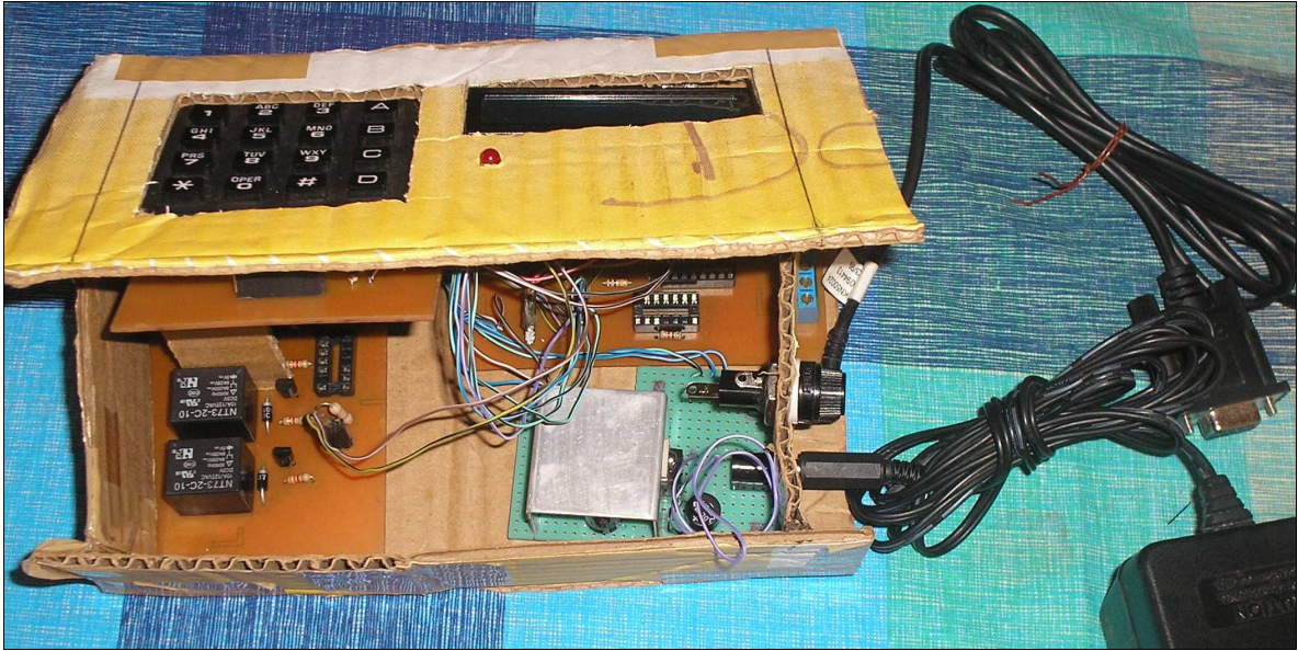
Figura 3.12: Diseño en cartón de la carcasa
