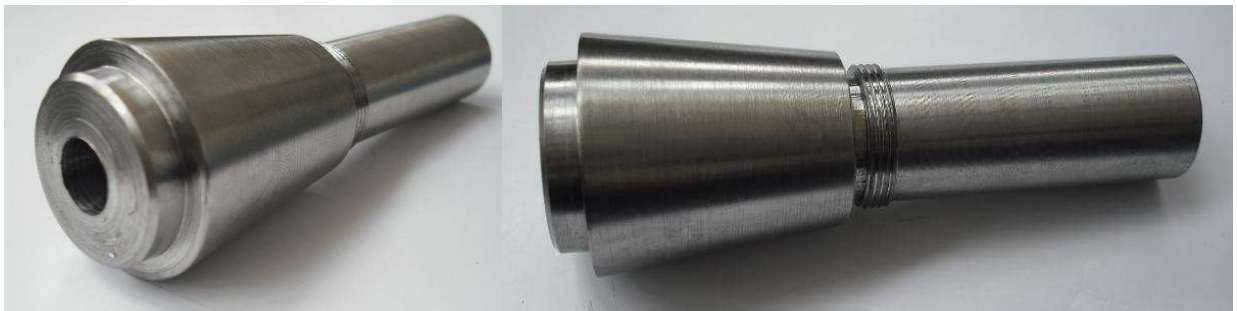
Figura 3.10. Proceso de maquinado del rotor terminado en torno.
