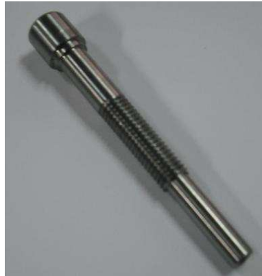
Figura 3.14. Eje de contrapeso terminado.
