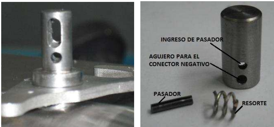
Figura 3.29. Terminal negativo y partes constitutivas.
