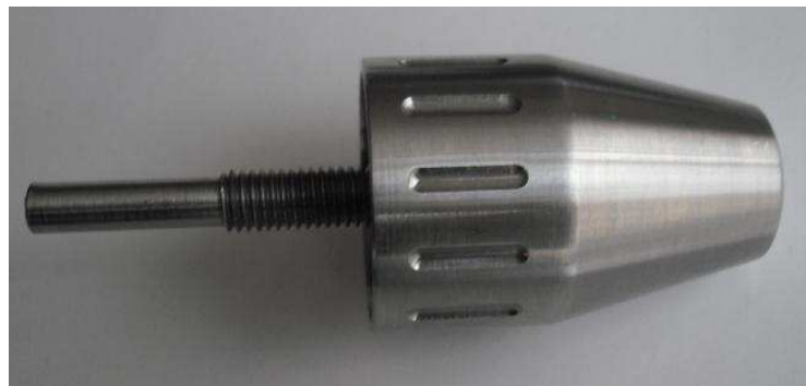
Figura 3.15a. Contrapeso vista exterior.
