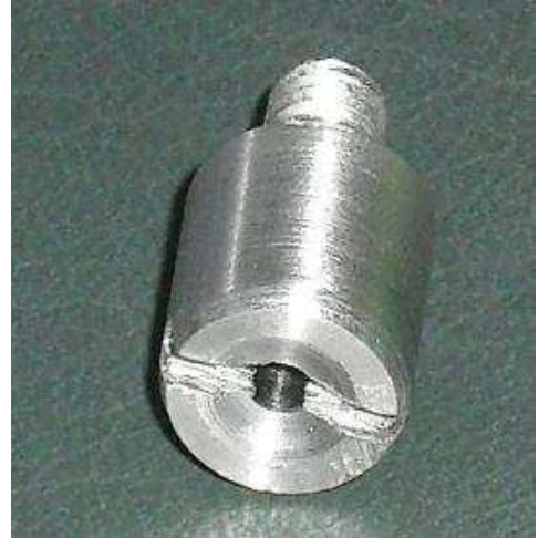
figura 3.30b. Tornillo interno de Terminal positivo.
