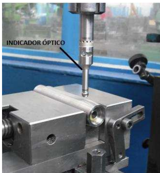
Figura 3.22. Buscador de borde óptico.
