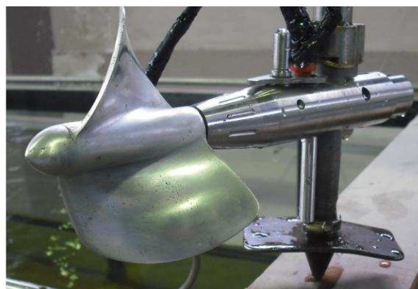
Figura 5.11 b. Hélice construida
