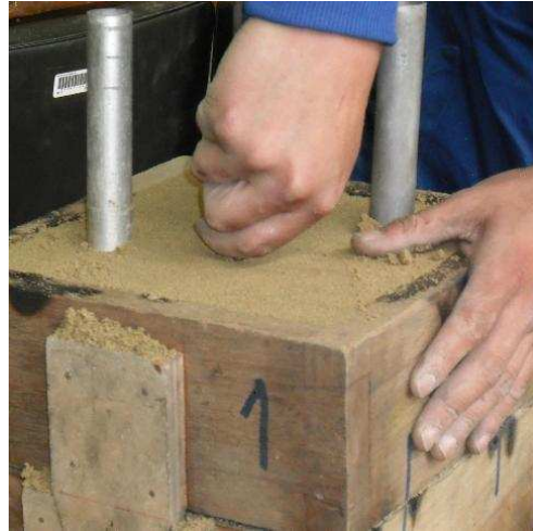
Figura 3.34. Agujeros de desfogue de gases.
