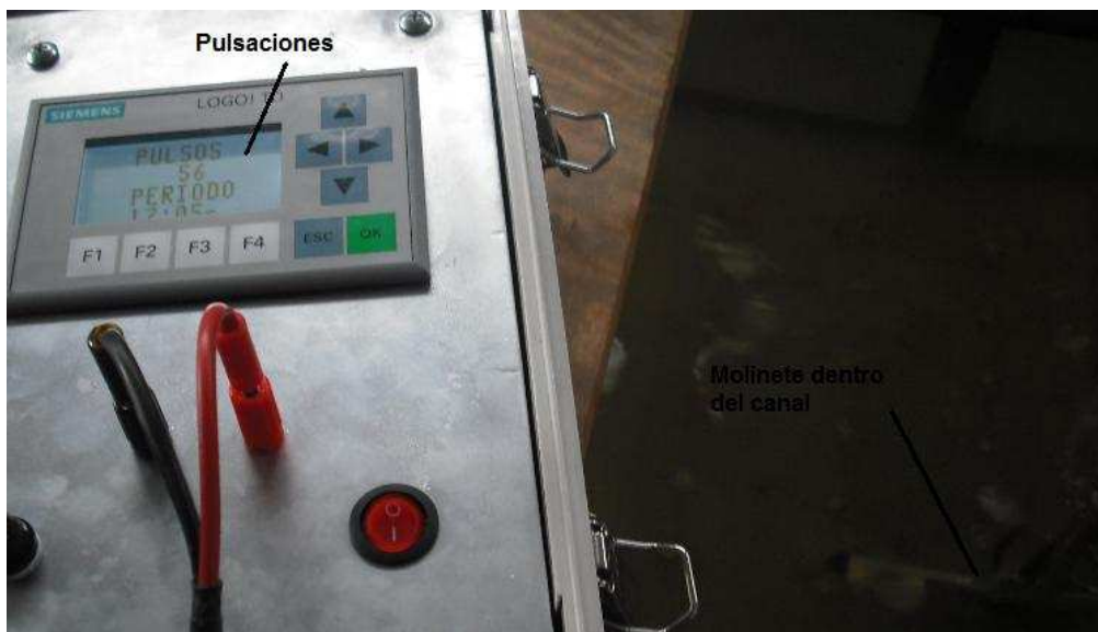
Figura 5.10. Registro de las pulsaciones emitidas por el molinete en el contador.
