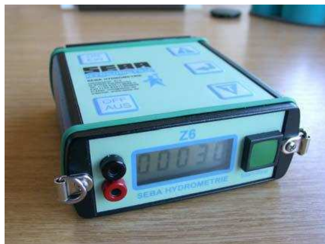
Figura 2.16. Contador SEBA para molinete.
