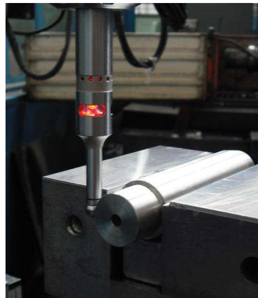
Figura 3.22. Buscador de borde óptico.
