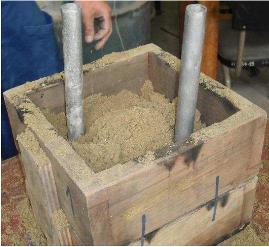
Figura 3.33. Canales del colado
