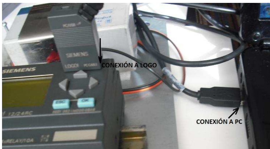
Figura 4.6. Conexión entre Logo y la PC
