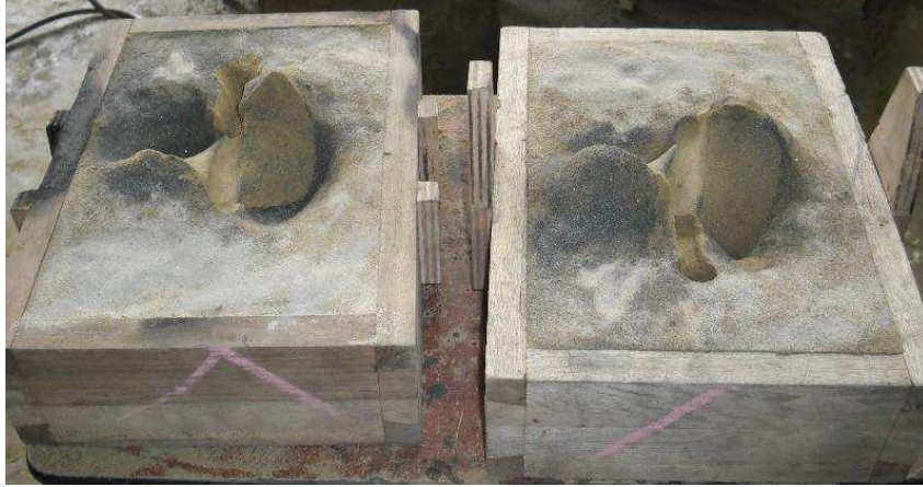
Figura 3.36. Moldeo de la hélice, \text{Ø}125\text{mm} y paso 250mm.
