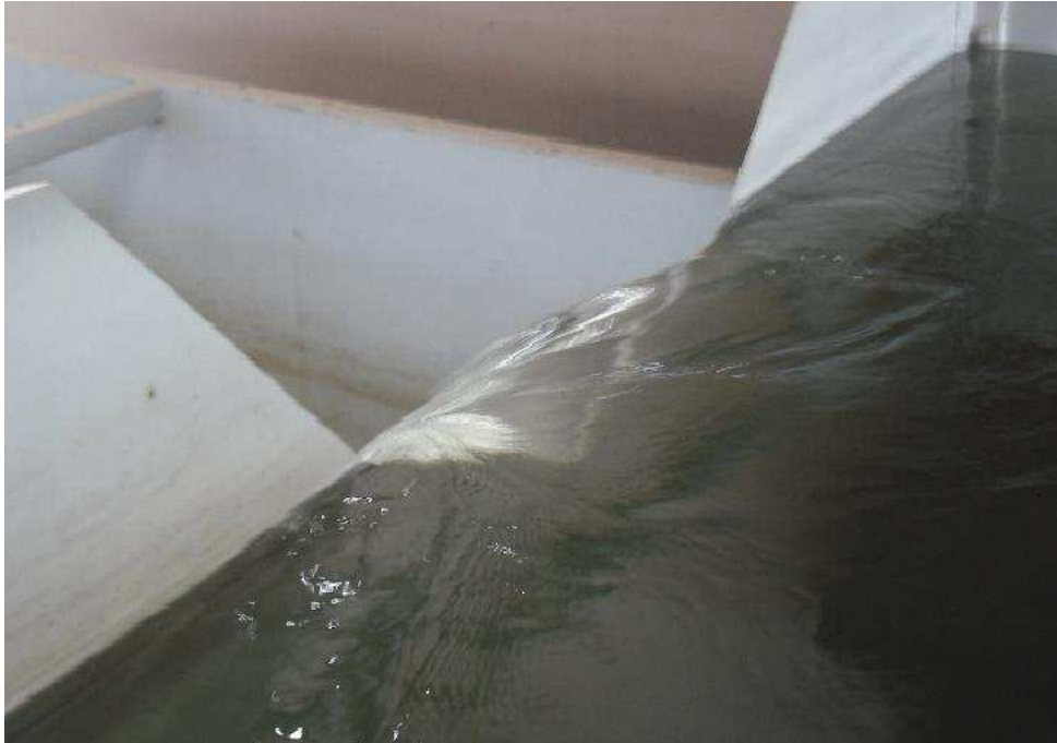
Figura 5.3. Vertedero triangular estandarizado de 90° del CIERHI.
