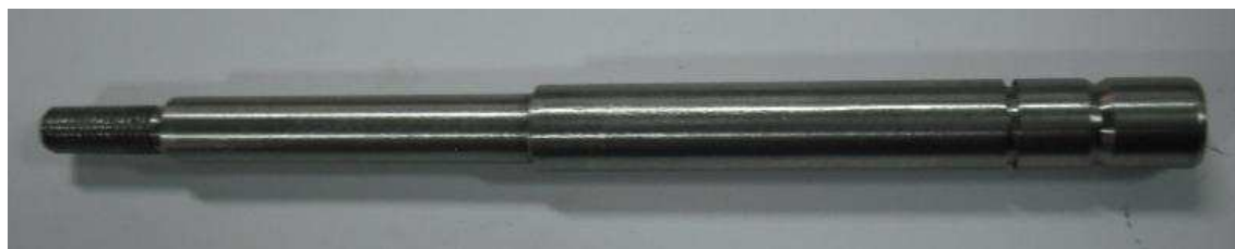
Figura 3.5. Eje métrico terminado.
