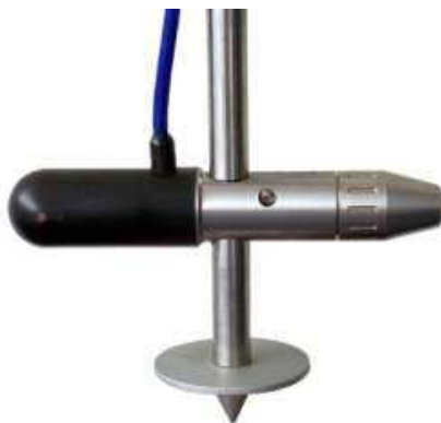
Figura 1.3. Sensor de flujo. (4)
