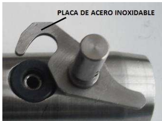
Figura 3.28. Terminal negativo del cuerpo.
