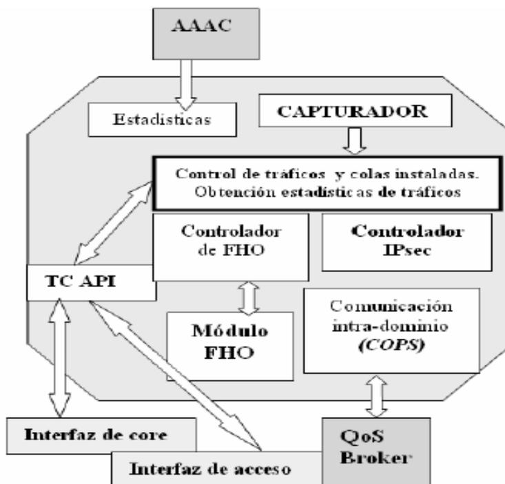
Figura 2. 8 Diagrama de bloques del Router de acceso<sup>55</sup>
