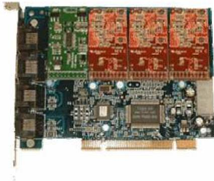
**Figura 2.11: tarjeta analógica TDM13B**
